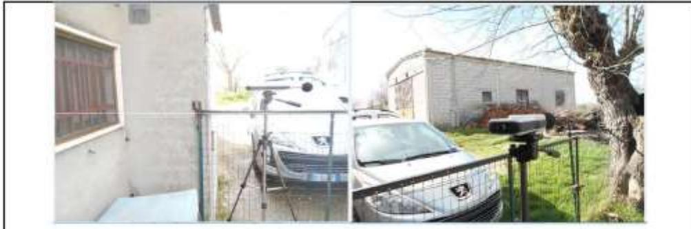
Foto 3. Fonometro piazzato nel punto di misura presso il ricettore R3 (foto destra), con microfono orientato verso le sorgenti stradale in progetto, vista prospetto fabbricato (foto sinistra).
