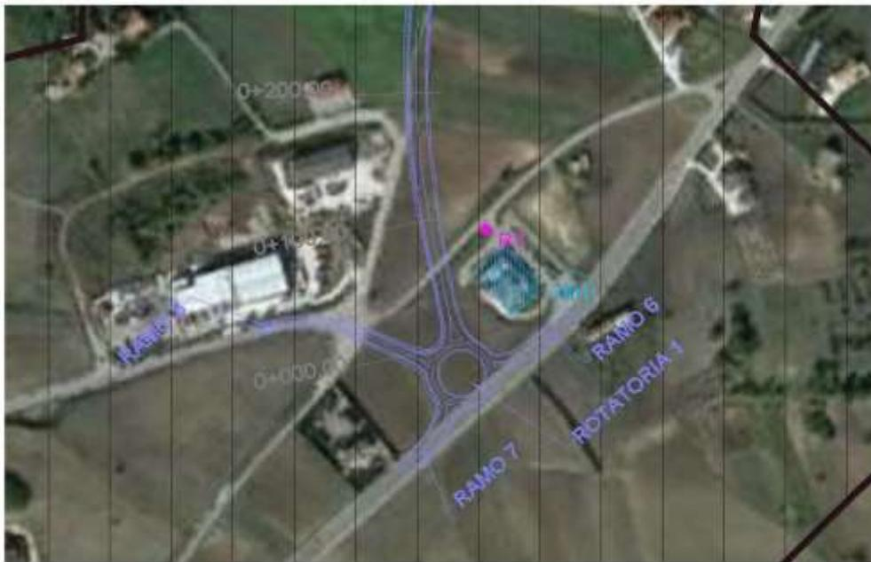
**Figura 1. Localizzazione del ricettore R1 rispetto alla strada in progetto (all'interno della fascia di pertinenza acustica di 250m). Si noti anche la posizione del punto di misura ("P1" in rosa)**
