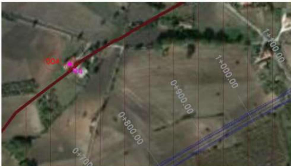
Figura 4. Localizzazione del ricettore R4 rispetto alla strada in progetto (al confine della fascia di pertinenza acustica di 250m). Si noti anche la posizione del punto di misura ("P4" in rosa)
