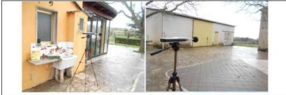
Foto 4. Fonometro piazzato nel punto di misura presso il ricettore R4 (foto destra), con microfono orientato verso le sorgenti stradale in progetto, vista prospetto fabbricato (foto sinistra).
