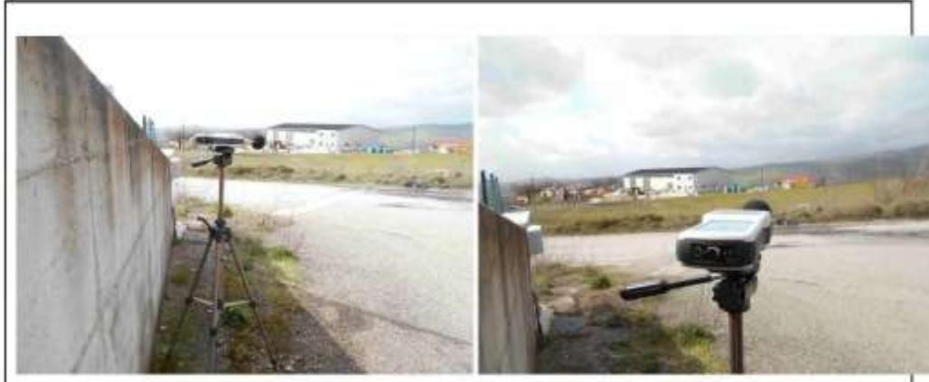
Foto 1. Fonometro piazzato nel punto di misura presso il ricettore R1 (foto destra), con microfono orientato verso le sorgenti stradale in progetto, vista muro perimetrale esterno (foto sinistra).
