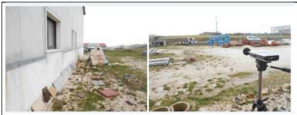
**Foto 2. Fonometro piazzato nel punto di misura presso il ricevitore R2 (foto destra), con microfono orientato verso le sorgenti stradale in progetto, vista prospetto fabbricato (foto sinistra).**
