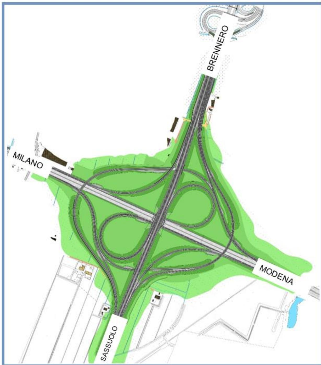
**Fig. 1/3.2 – Configurazione del nuovo svincolo A22/A1**
