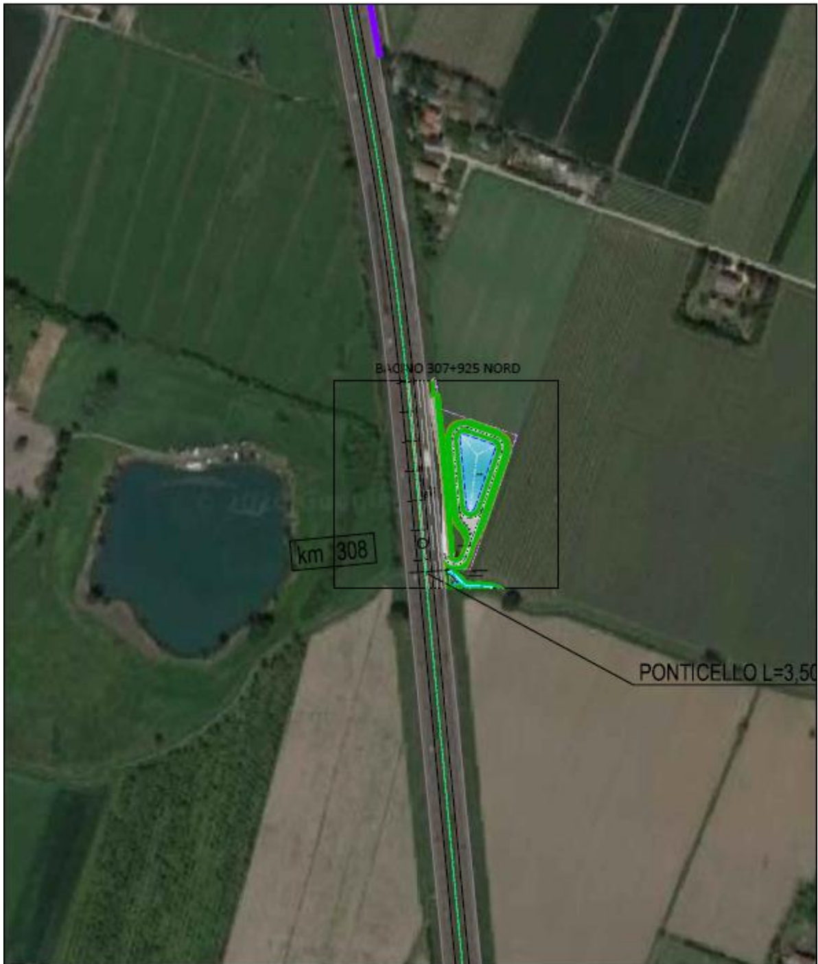
Fig. 2/2.2.3 – Bacino di laminazione BL64 al km 307+925 presso il Cavo Lama
