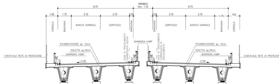
SEZIONE TIPO VIADOTTO - CASSONI CORSIA DI ACCELERAZIONE/DECELERAZIONE
