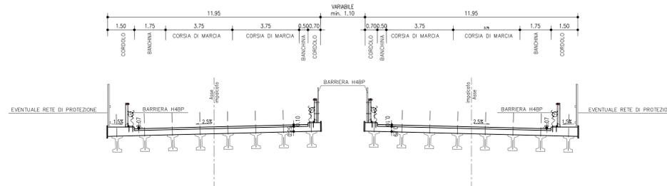
SEZIONE TIPO VIADOTTO - TRAVI CORSIA DI ACCELERAZIONE/DECELERAZIONE
