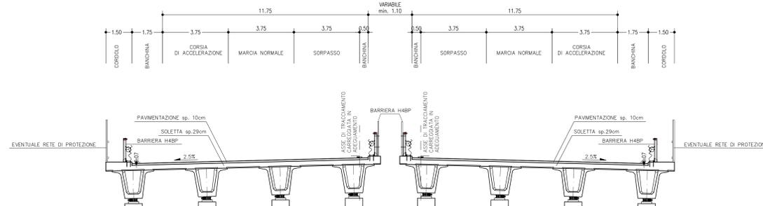
SEZIONE TIPO VIADOTTO - TRAVI - IN RETTILINEO
