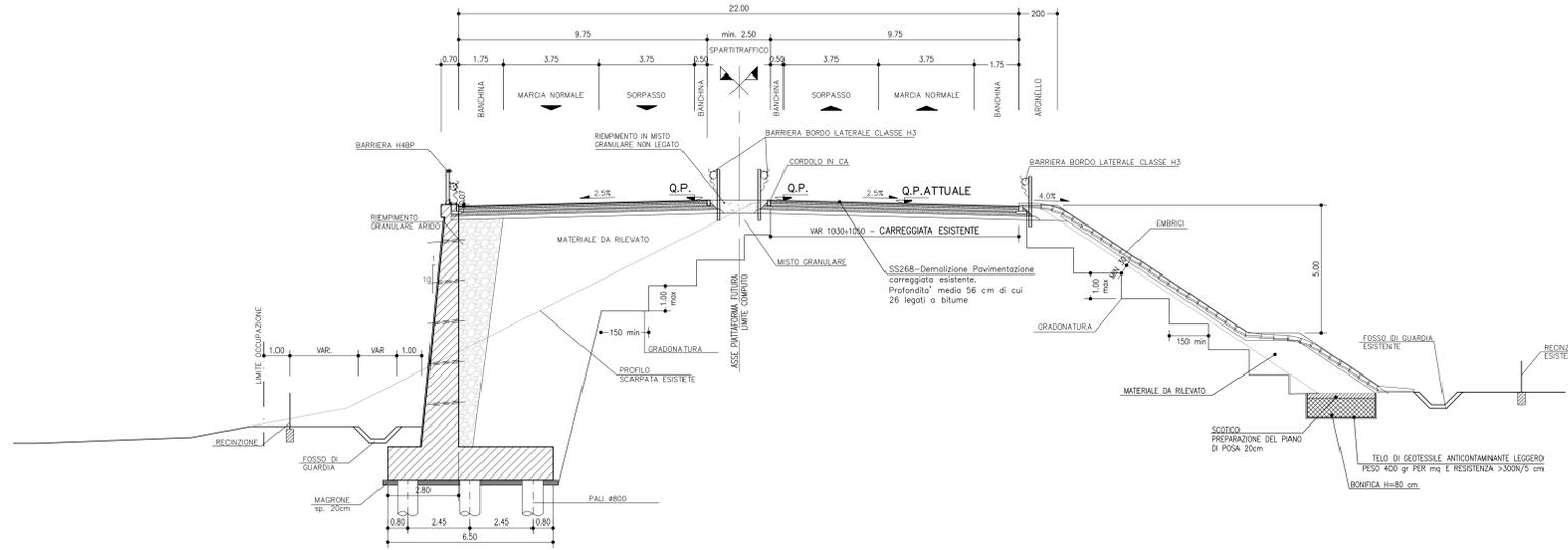
SEZIONE TIPO IN RILEVATO IN RILEVATO CON MURO DI SOSTEGNO SU ASSE PRINCIPALE E RAMPA MONODIREZIONALE
