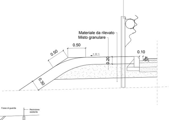
DETTAGLIO PAVIMENTAZIONE -Scala 1:20-
