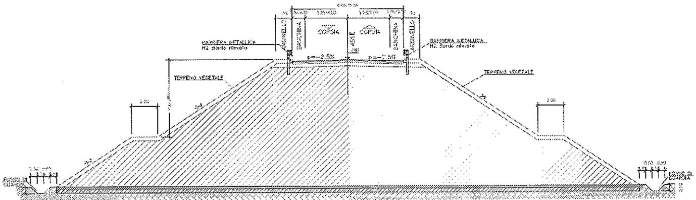
Figura 1 - Sezione tipo cat. F2 (D.M. 5/11/2001) per  $H > 6.00m$
