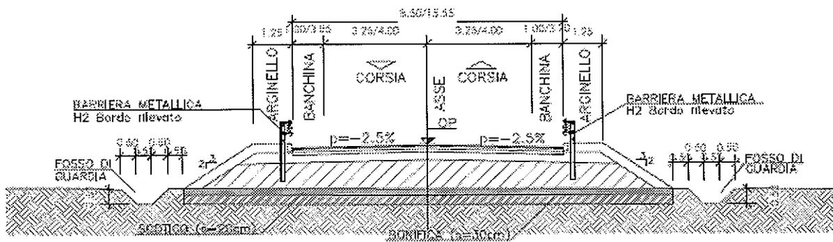
Figura 2 - Sezione tipo cat. F2 (D.M. 5/11/2001) per  $H \leq 6.00m$
