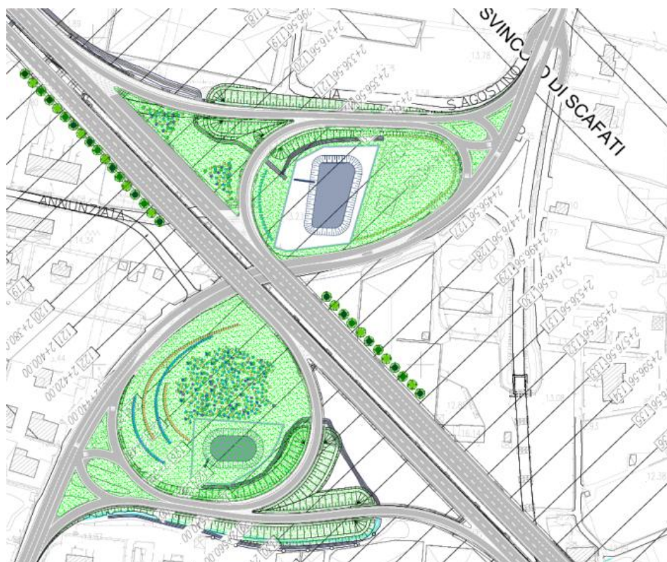
Figura 5-8: Lotto 2 - Sistemazione a verde aree svincolo Scafati
