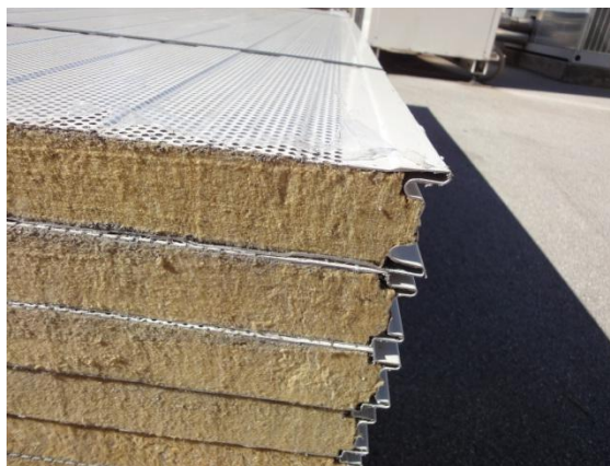
Figura 5-13: Esempio di pannelli fonoassorbenti
