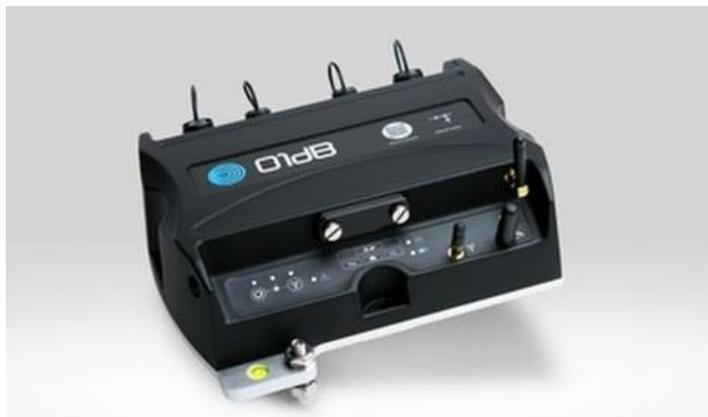
*Esempio di analizzatore di vibrazioni*
