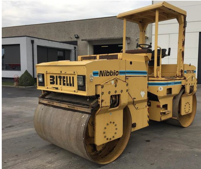
Figura 17 - Rullo compattatore vibrante a doppio tamburo
