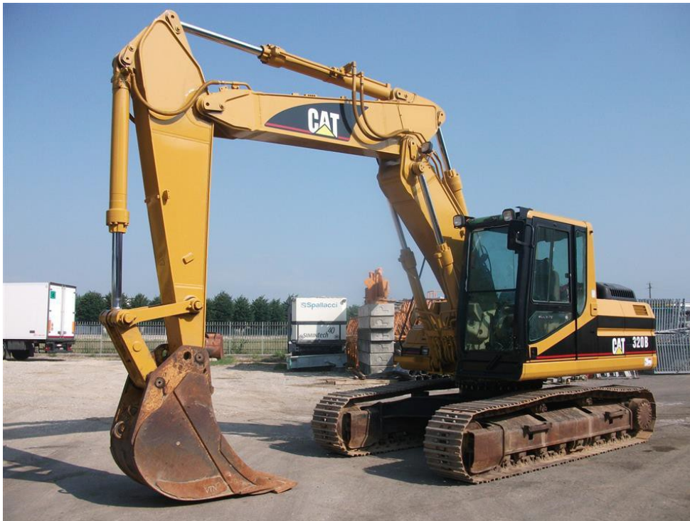
Figura 8 - Escavatore cingolato per lavori di scavo
