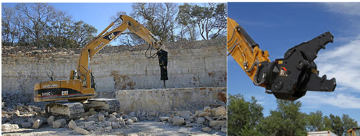
Figura 10: Escavatore cingolato dotato di martello demolitore (a sinistra) e di pinza demolitrice (a destra)
