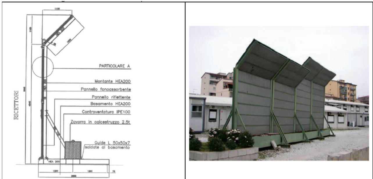
Figura 5 – Esempi barriere antirumore.
