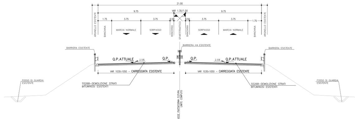
SEZIONE TIPO IN RILEVATO IN RETTIFILLO ( 0+300/0+400)
