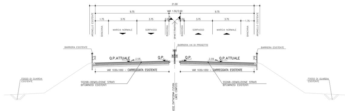
SEZIONE TIPO IN RILEVATO IN RETTIFILLO
