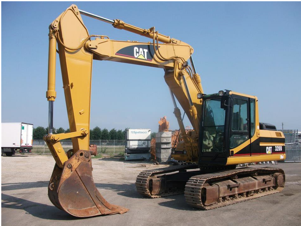
Figura 14 - Escavatore cingolato per lavori di scavo
