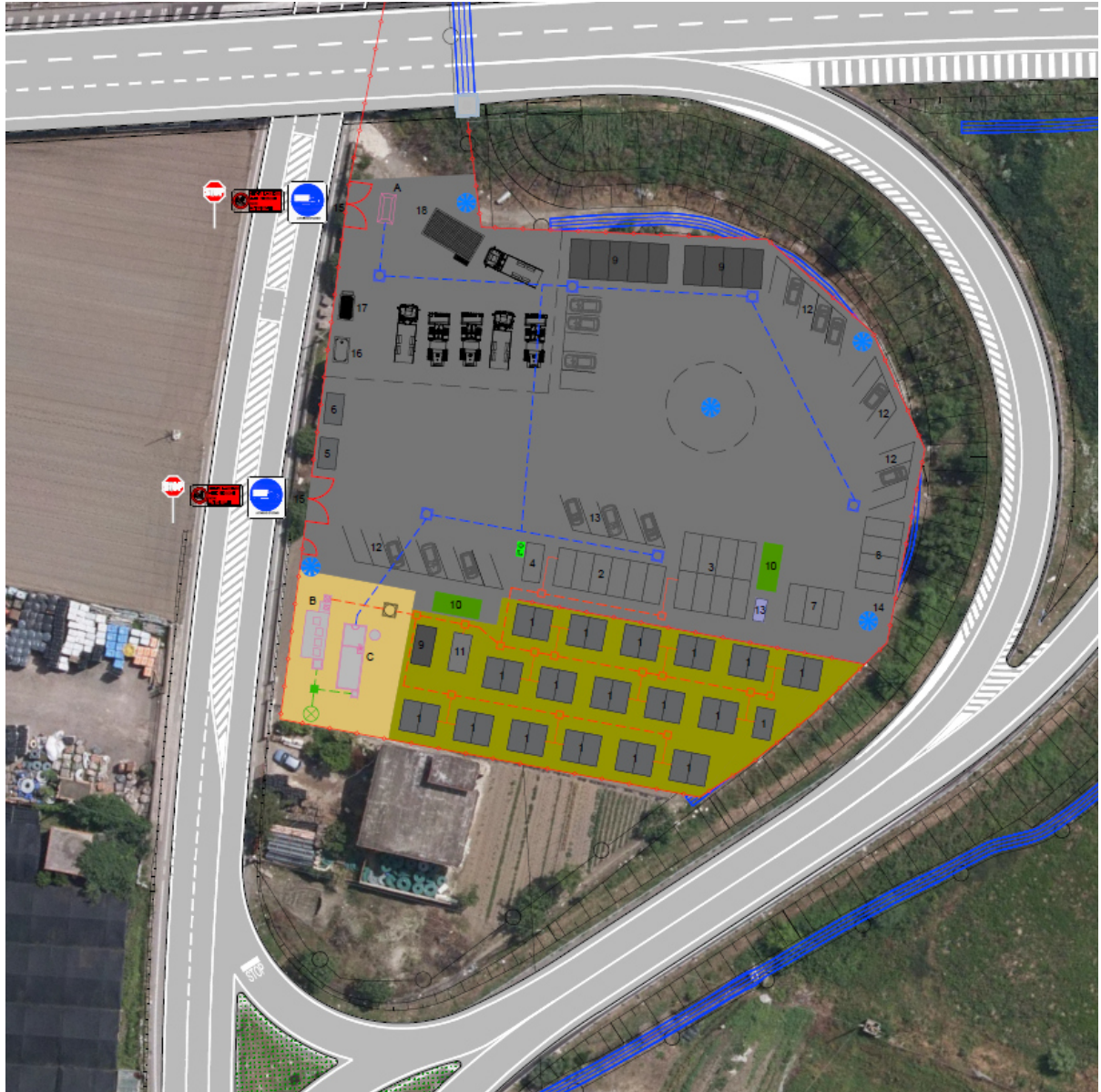
Figura 3 - Layout del cantiere base CB
