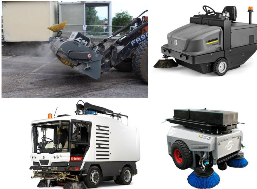
*Figura 1 – Esempi di macchine spazzatrici da cantiere*
