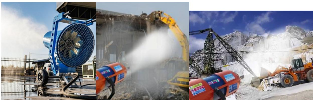
Figura 4 – Esempi di sistemi di abbattimento delle polveri.
