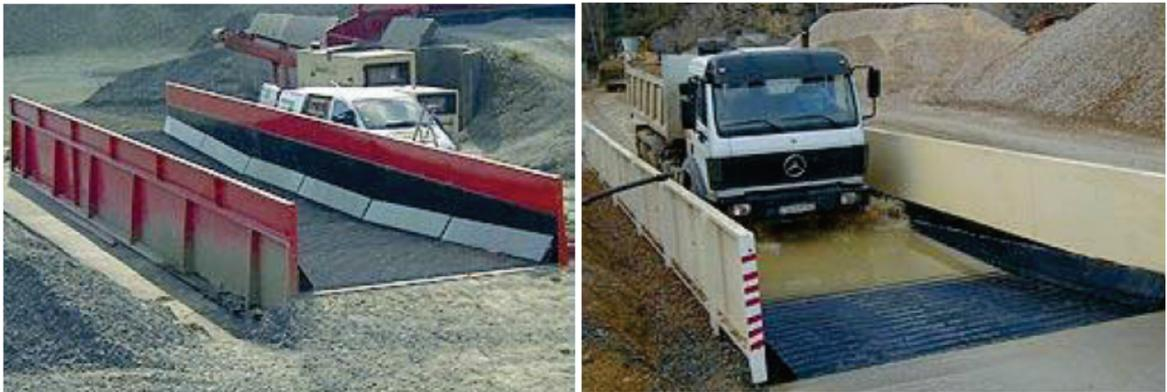
*Figura 3 – Esempi di sistemi di lavaggio degli pneumatici (A BACINO).*
