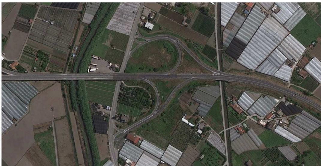
La connessione risulta essere completa per manovre di ingresso e uscita; la nuova carreggiata si sviluppa principalmente lato Sud, tutte le rampe ribattono parzialmente il tracciato esistente rettificando gli attacchi in relazione alla geometria variata delle carreggiate principali. Anche in questo caso il progetto adegua le corsie di immissione ed uscita secondo i criteri funzionali e geometrici della normativa di settore.
