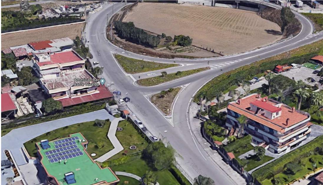
Si è scelto di riproporre, per coerenza con il territorio e limitazione degli ingombri, **intersezioni a raso di tipo lineare** (intersezioni "a T") con conformazione a 3 rami. Sono state quindi evitate circolazioni di tipo a rotatoria. Concettualmente l'intersezione è stata geometrizzata tramite i suoi elementi caratteristici secondo lo schema seguente:
