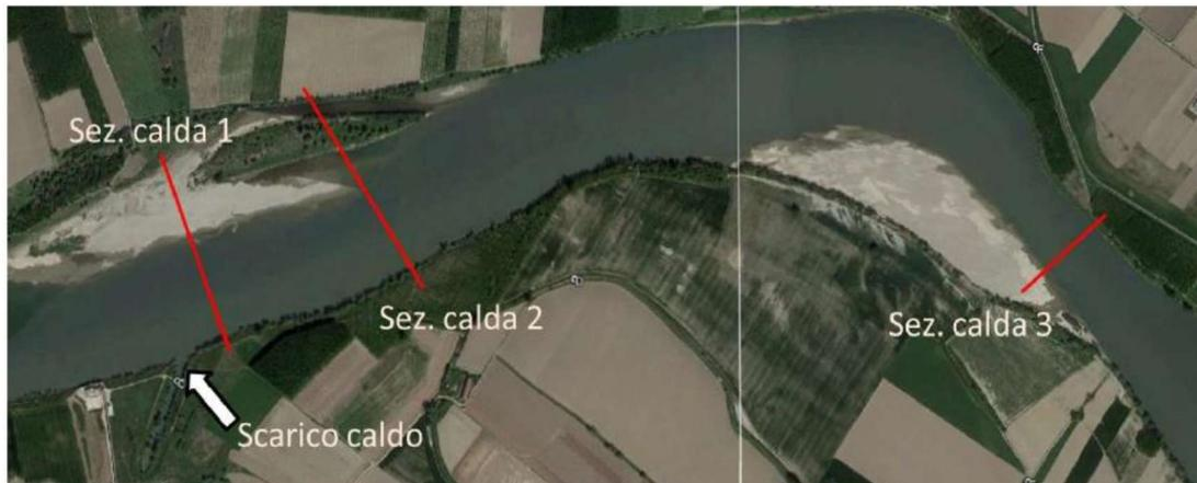
L'analisi degli scenari simulati con il codice di calcolo MIKE 21 in condizione di funzionamento della centrale a pieno carico individua che la perturbazione termica tende a mantenersi in corrispondenza della sponda destra del fiume per un ampio tratto del Po a valle dello scarico. Dalla sezione calda 3 si osserva l'instaurarsi di condizioni di maggiore rimescolamento che conducono ad una distribuzione uniforme della temperatura poco a valle della sezione stessa.
