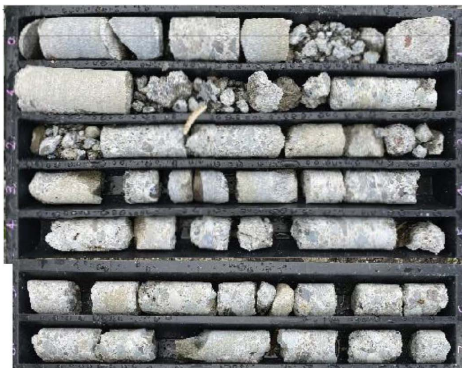
Fig. 3-6: Calcestruzzo pila 6, Sondaggio S2, da 0 a 7 m, (Geotecnica Palazzi-Giomarelli srl, 2020)
