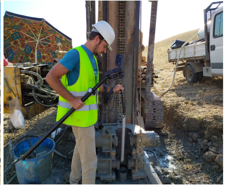
Figura 2 – Rilievo masse metalliche superficiali e in foro mediante Magnetometro MAGNEX 120LW
