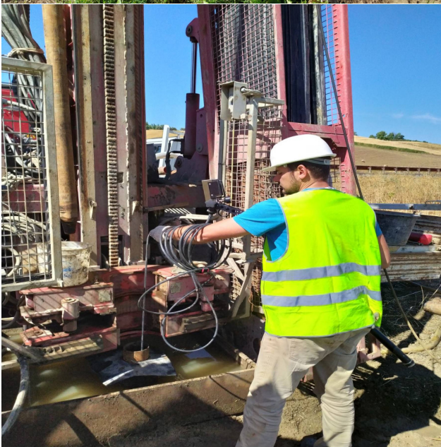
Figura 2 – Rilievo masse metalliche superficiali e in foro mediante Magnetometro MAGNEX 120LW
