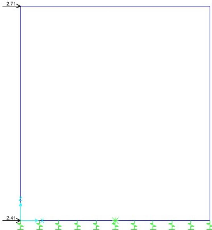
Tab. 35 -Modello - SPQSX71: spinta del terreno statica sulla parete sinistra per il sovraccarico accidentale LM71
