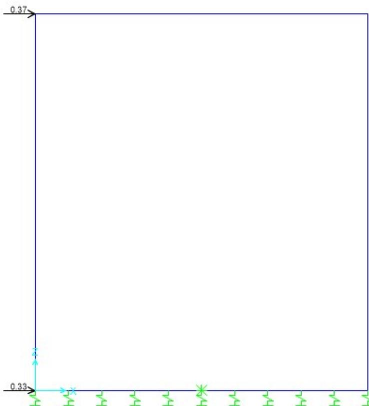
Tab. 40 –Modello - SPQSXSW:spinta del terreno statica sulla parete sinistra per il sovraccarico accidentale SW
