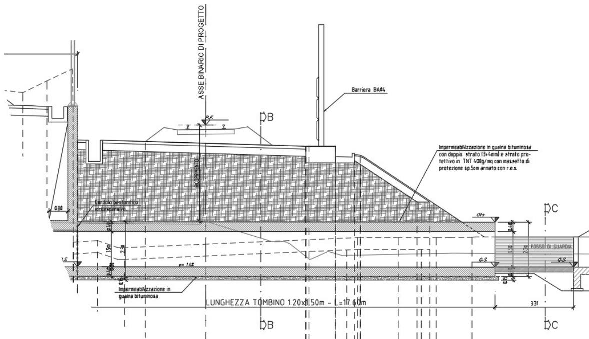
Tab. 3 – Tombino scatolare idraulico -66+794,807 - Sezione longitudinale
