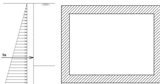
Tab. 10 – Schema per il calcolo degli effetti della spinta statica del terreno
