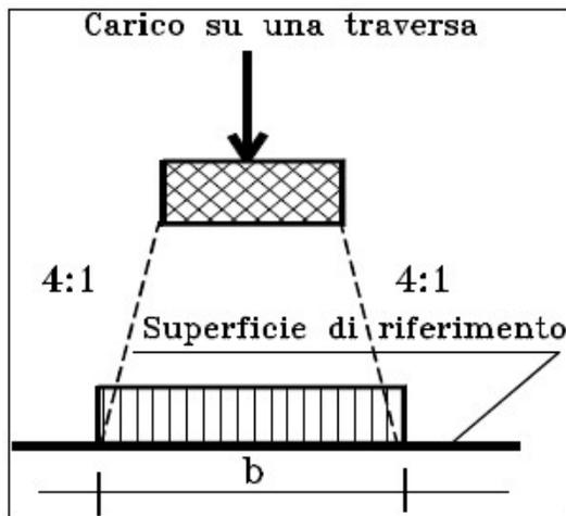
Tab. 15 – Diffusione longitudinale del carico ferroviario
