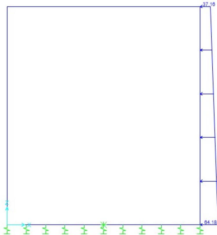
Tab. 32 - Modello - SPTDX: spinta del terreno statica sulla parete destra
