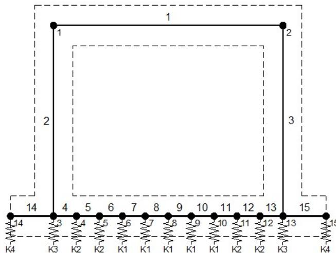
Tab. 50 – Schematizzazione del modello scatolare
