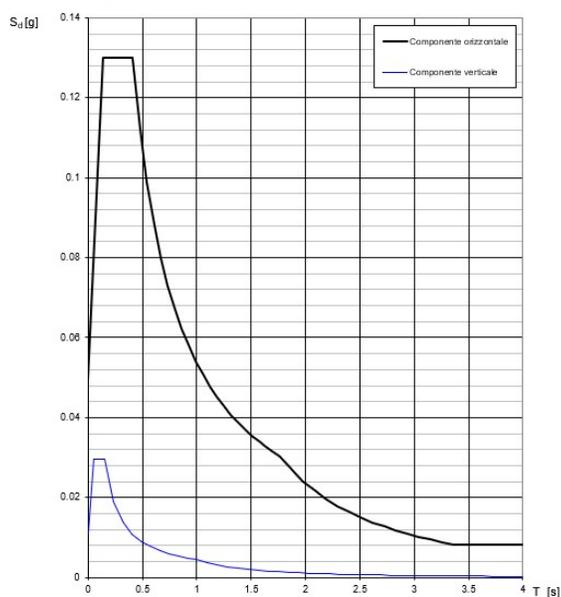
Di seguito si riporta a titolo di esempio lo **spettro di progetto** per lo **Stato Limite di salvaguardia della Vita SLD** relativamente alle componenti **orizzontali**, con coefficiente di smorzamento strutturale canonico pari al 5%.
