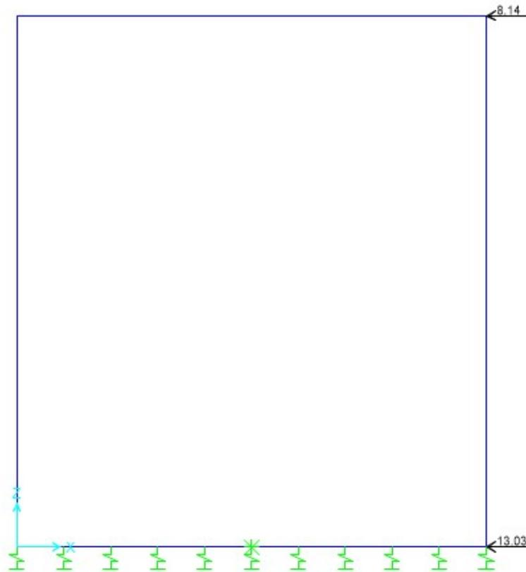
Tab. 33 - Modello - SPTDX: spinta del terreno statica sulla parete destra
