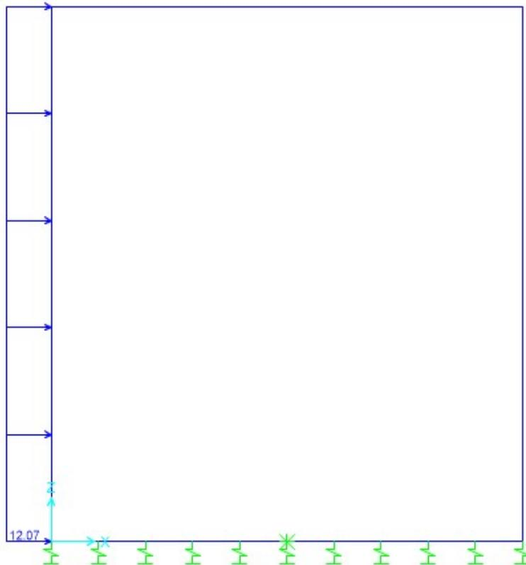
Tab. 34 –Modello - SPQSX71: spinta del terreno statica sulla parete sinistra per il sovraccarico accidentale LM71
