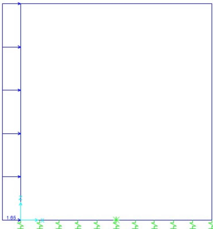
Tab. 39 –Modello - SPQSXSXW:spinta del terreno statica sulla parete sinistra per il sovraccarico accidentale SW
