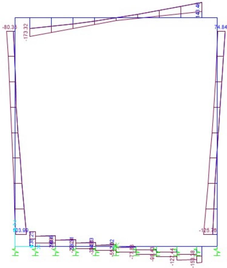
Tab. 57 – Modello scatolare - Involuppo SLU sforzo di taglio
