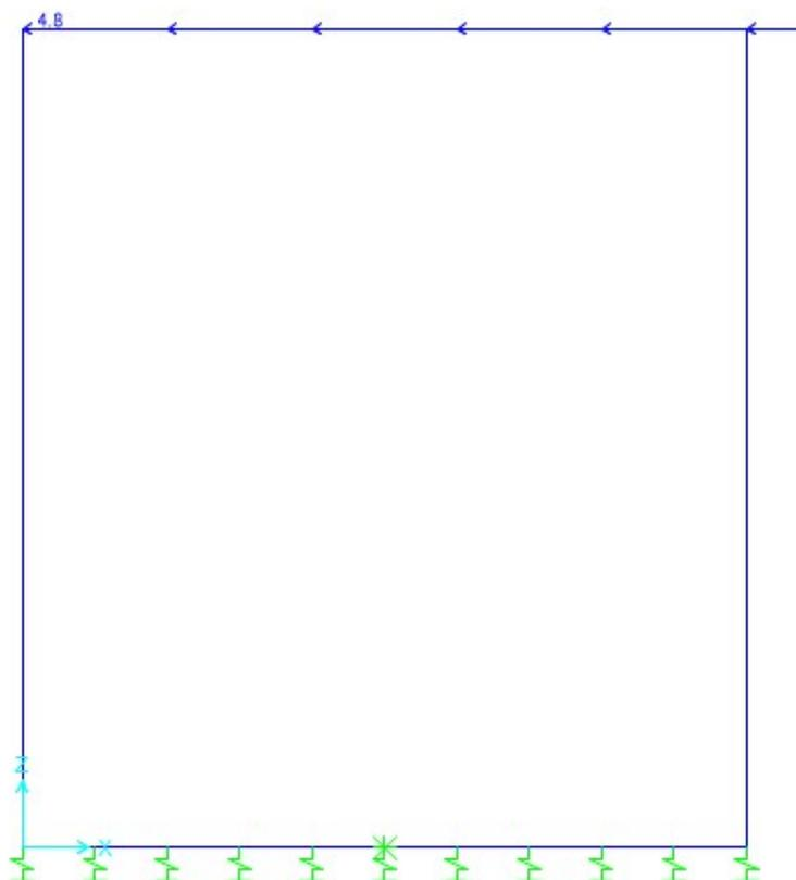
Tab. 29 –Modello - AVV: azione di accelerazione e frenatura
