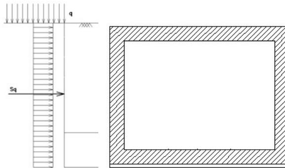
Tab.16 – Schema per il calcolo degli effetti della spinta dovuta al sovraccarico accidentale
