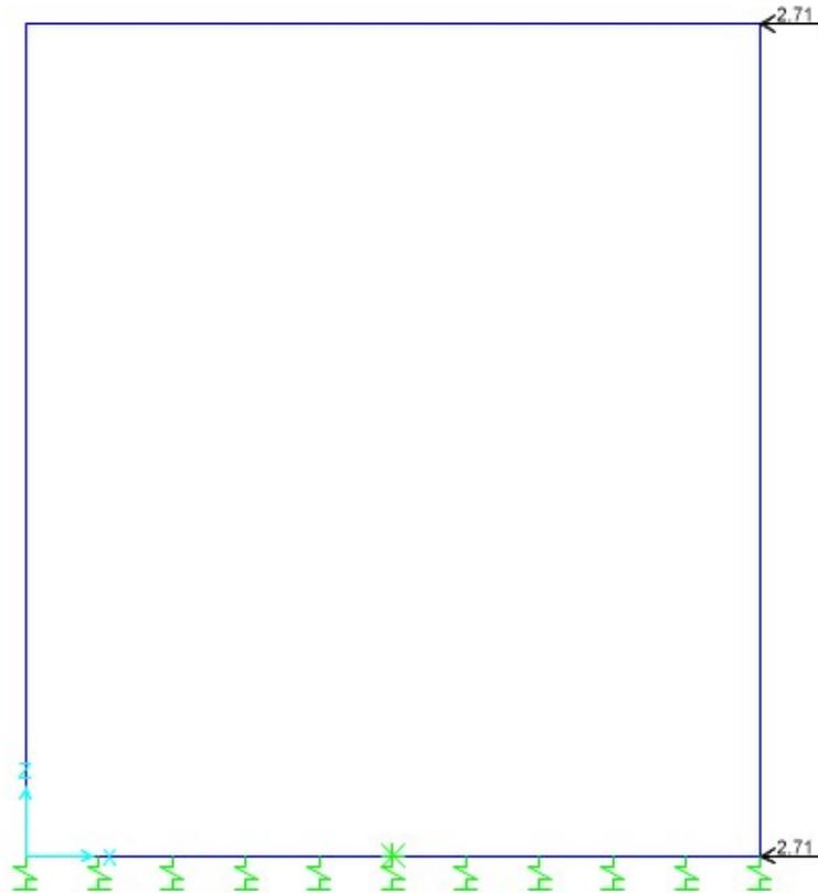
Tab. 37 –Modello - SPQDX71: spinta del terreno statica sulla parete destra per il sovraccarico accidentale LM71
