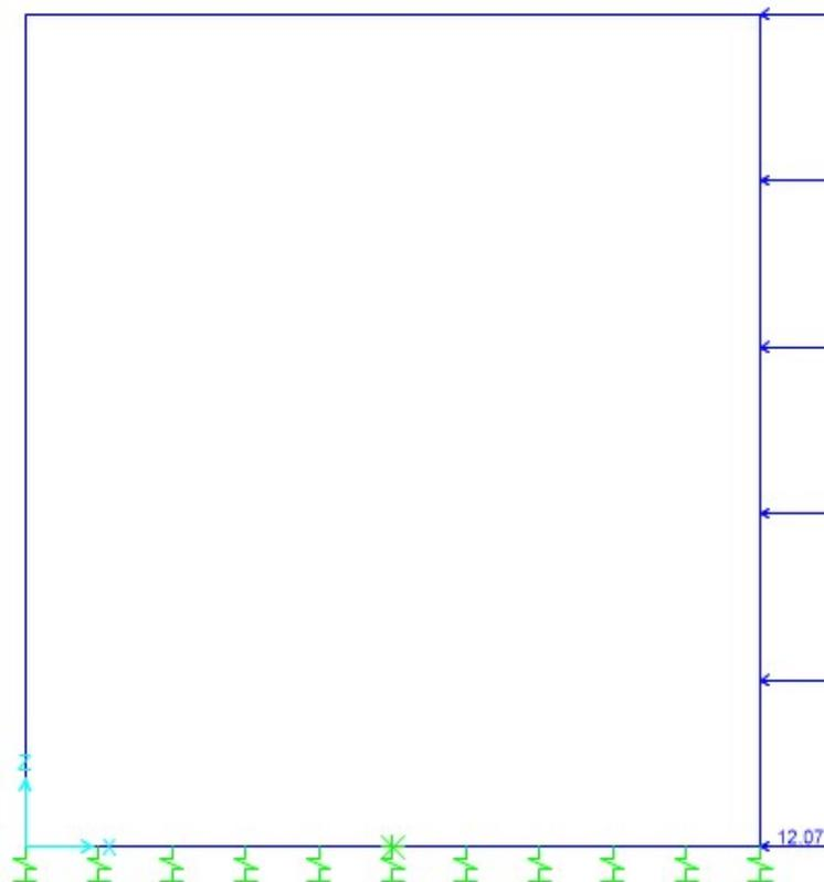
Tab. 36 –Modello - SPQDX71: spinta del terreno statica sulla parete destra per il sovraccarico accidentale LM71
