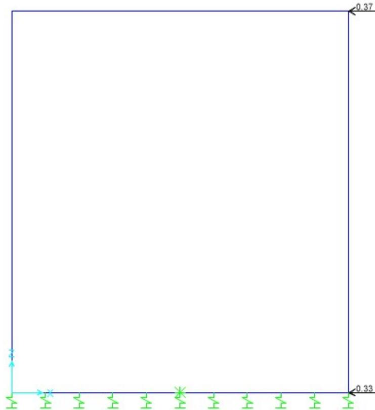
Tab. 42 -Modello - SPQDXSW:spinta del terreno statica sulla parete destra per il sovraccarico accidentale SW
