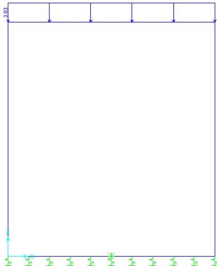
Tab. 46 –Modello - SISMAV: azione sismica verticale sulla struttura dello scatolare
