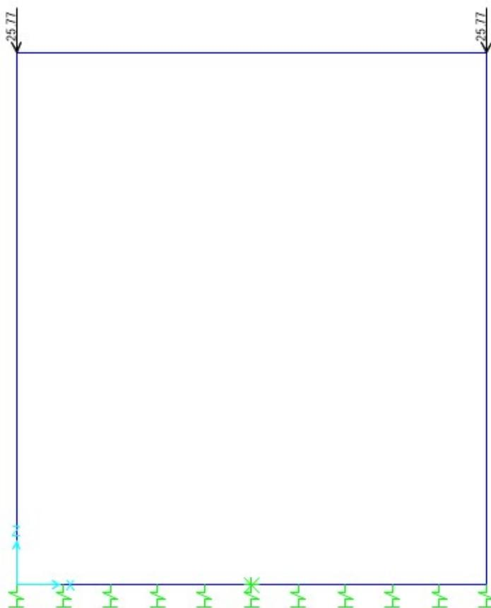
Tab. 26 -Modello - PERM-G2: carichi permanenti non strutturali
