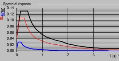
— Spettro di progetto - componente orizzontale
