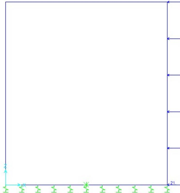
Tab. 47 -Modello - SPSPDX: sovraspinta sismica del terreno
