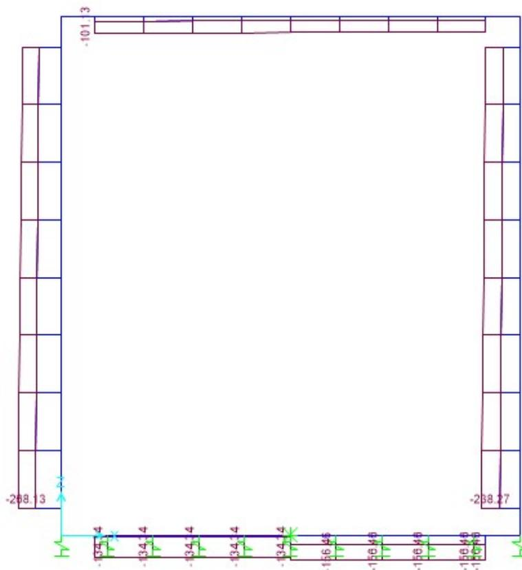
Tab. 56 – Modello scatolare – Involuppo SLU sforzo normale
