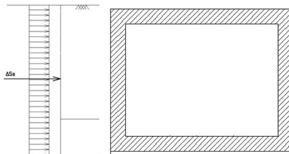
Tab. 18 – Schema per il calcolo degli effetti della sovrappinta sismica del terreno
