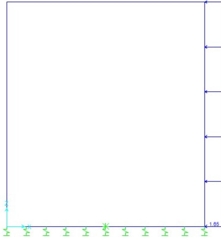
Tab. 41 –Modello - SPQDXSW:spinta del terreno statica sulla parete destra per il sovraccarico accidentale SW
