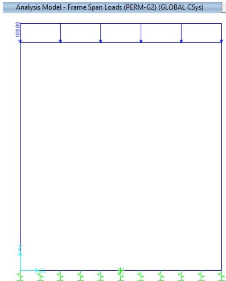
Tab. 25 –Modello - PERM-G2: carichi permanenti non strutturali
