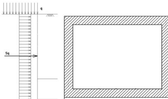
Tab. 11 – Schema per il calcolo degli effetti della spinta dovuta al sovraccarico accidentale
