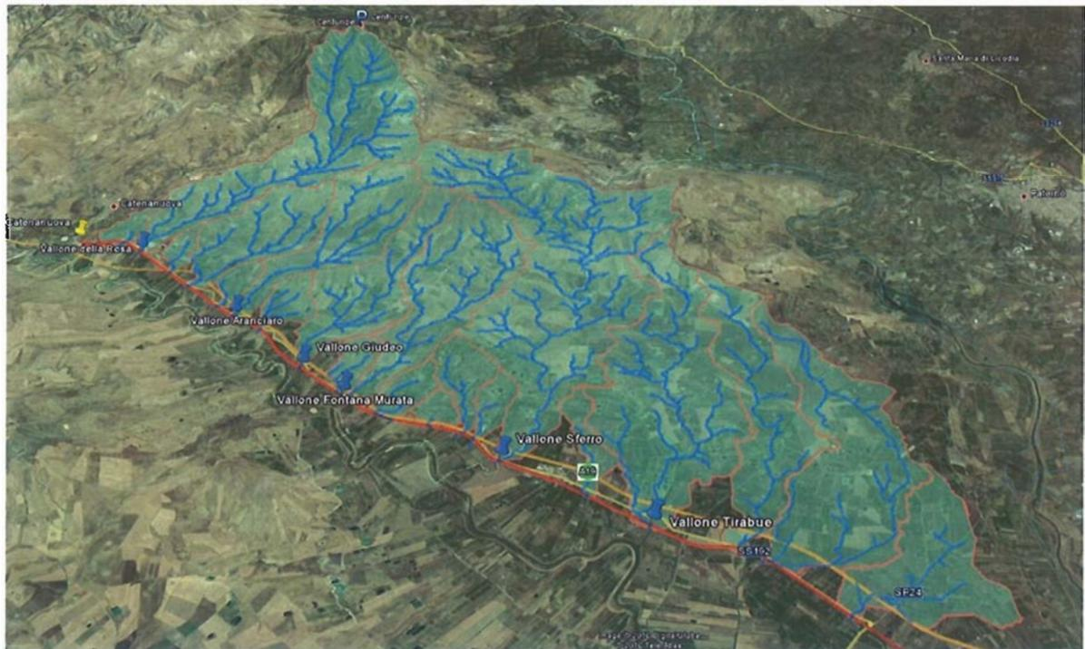
*Figura 4 - Ricostruzione dell'idrografia di una porzione della zona di studio, con la suddivisione dei bacini afferenti alle opere di attraversamento.*
