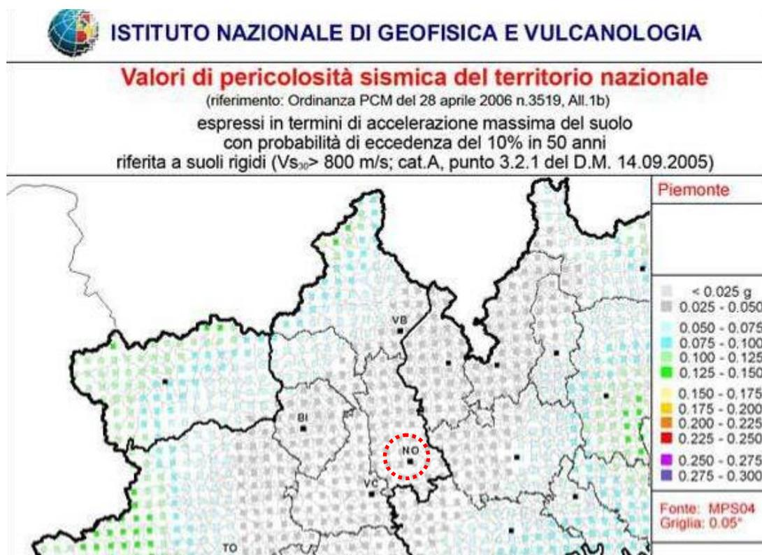
**Figura 8-2. Mappa di pericolosità sismica espressa in termini di accelerazione massima del suolo ( $a_{max}$ ) con probabilità di eccedenza del 10% in 50 anni riferita a suoli molto rigidi ( $V_{s,30} > 800$  m/s) – da INGV.**
