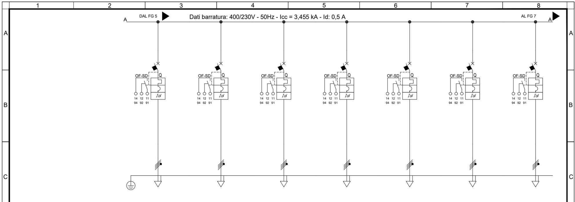
Dati barratura: 400/230V - 50Hz - Icc = 3,455 kA - Id: 0,5 A
