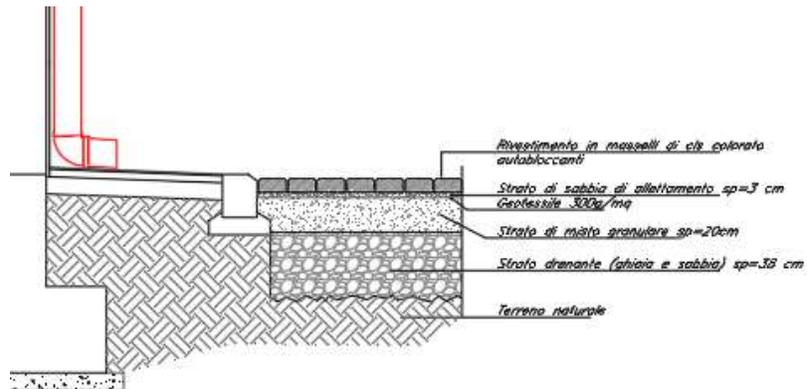
Figura 11 – Dettaglio scarico pluviale.
