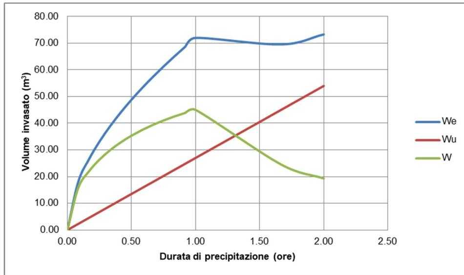
**Figura 11: Diagramma durata di precipitazione – Volume da invasare**
