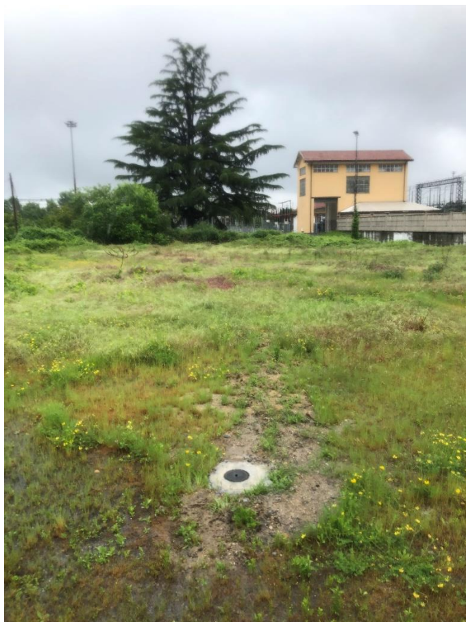
Figura 50 - Pozzetto protezione del tubo piezometrico posto nel sondaggio PDNB01_S5.
