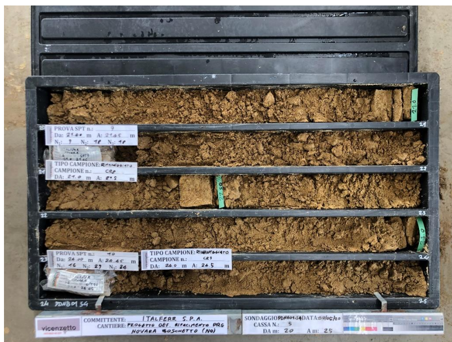
Figura 38- Sondaggio PDNB01_S4, profondità 20,00-25,00m.
