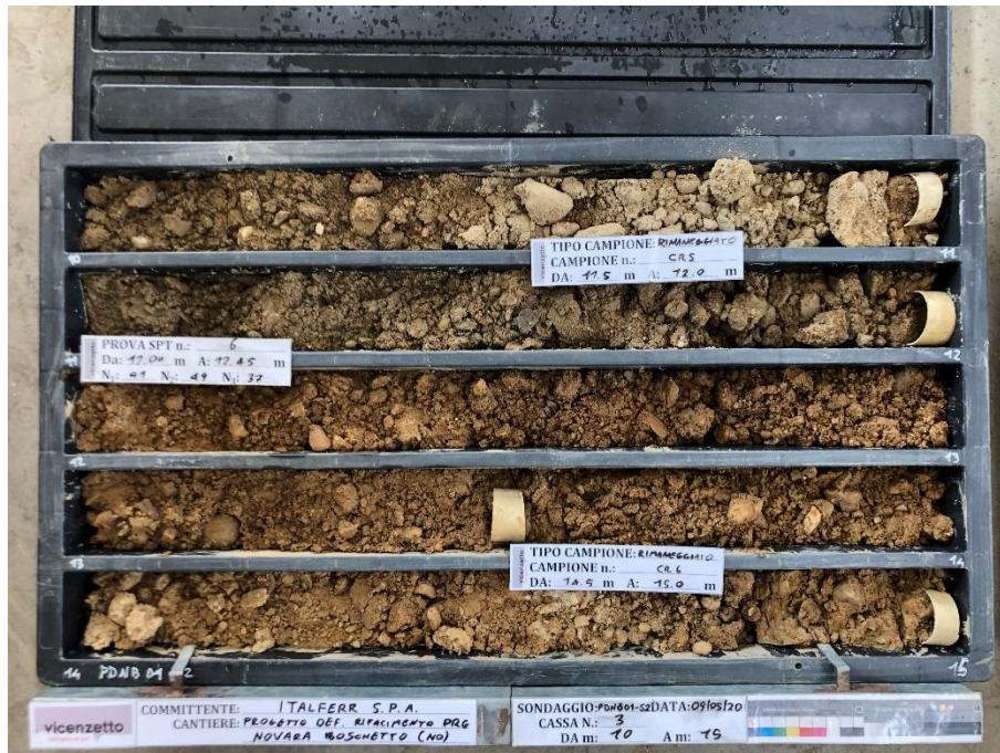
Figura 16 - Sondaggio PDNB01_S2, profondità 10,00-15,00m.
