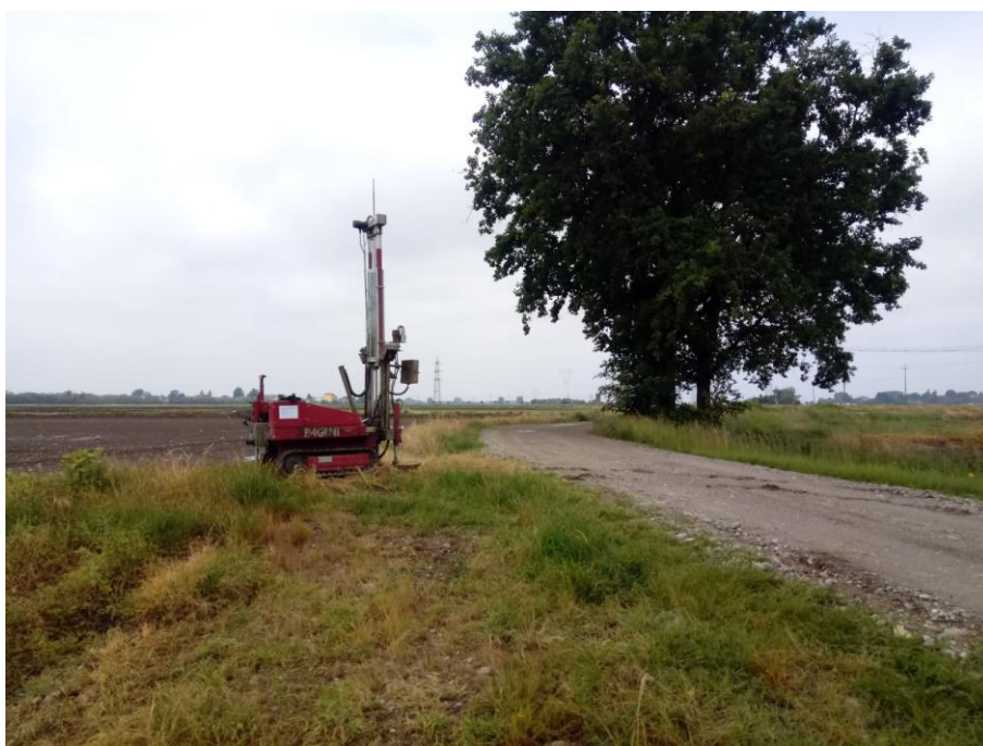
Figura 5 – Penetrometro approntato nella prova DPSH02
