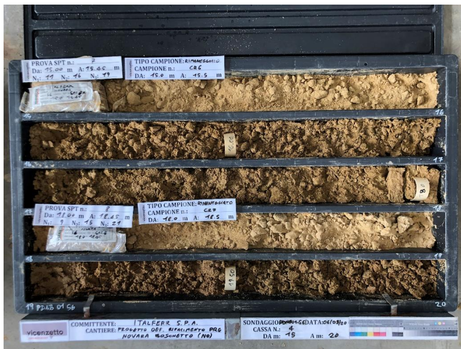
Figura 57 - Sondaggio PDNB01_S6, profondità 15,00-20,00
