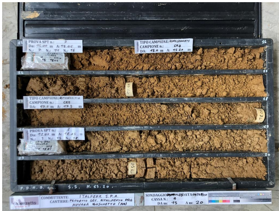
Figura 47 - Sondaggio PDNB01_S5, profondità 15,00-20,00
