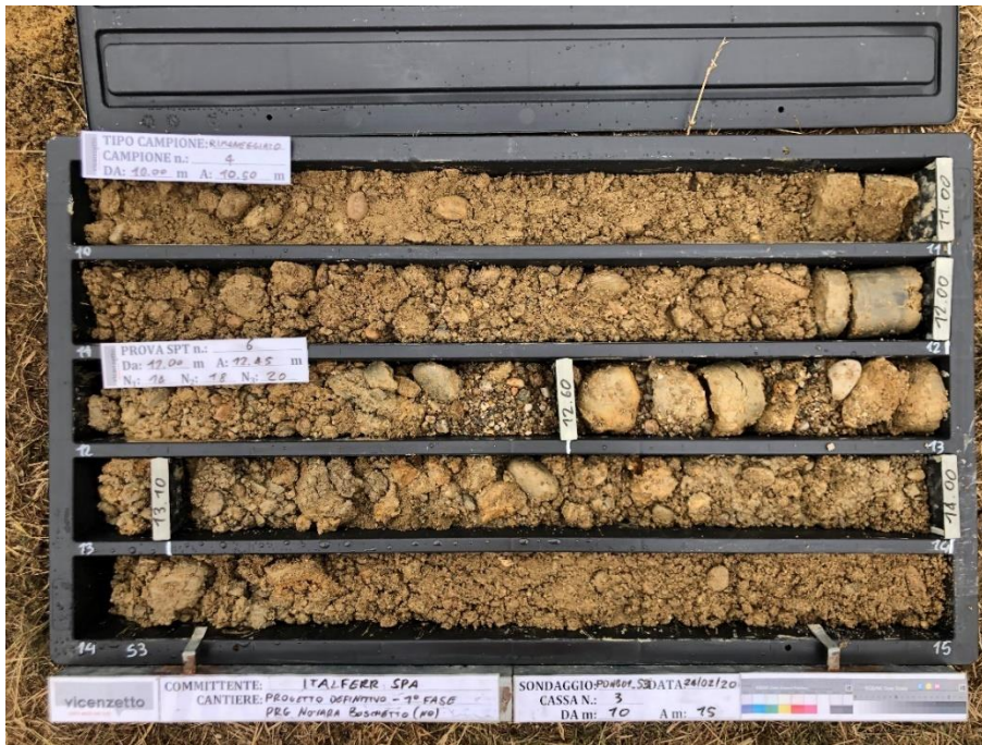
Figura 26 - Sondaggio PDNB01_S3, profondità 10,00-15,00m.
