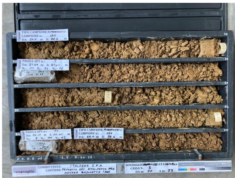
Figura 48 - Sondaggio PDNB01_S5, profondità 20,00-25,00m.
