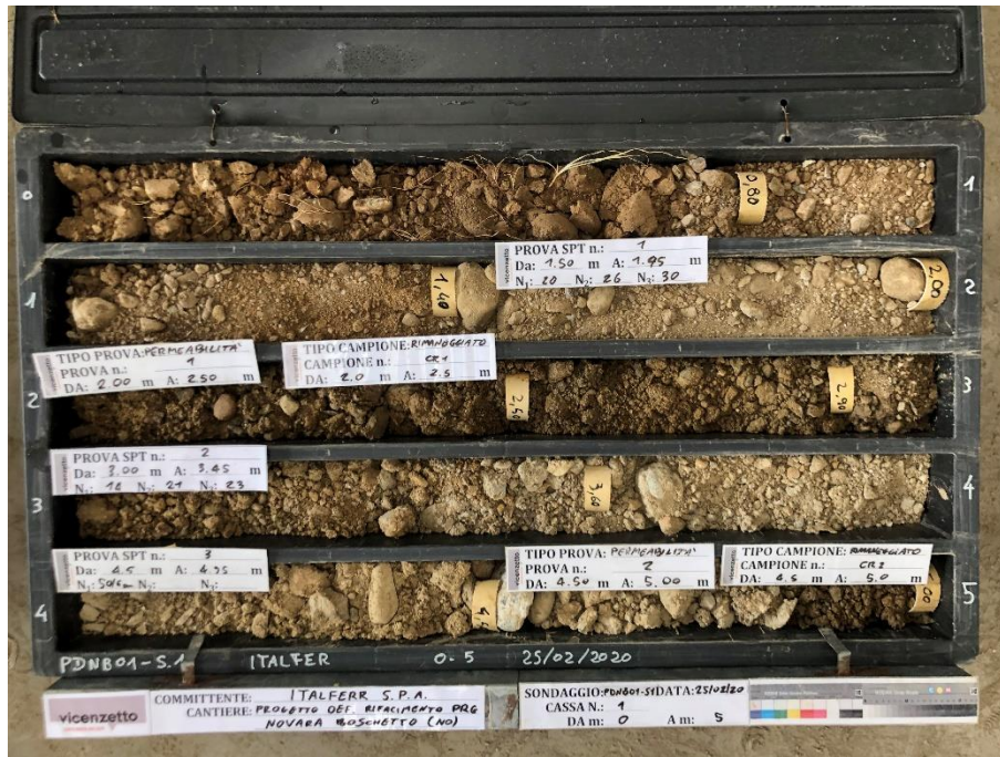
Figura 4 – Sondaggio PDNB01_S1, profondità 0,00 -5,00m.
