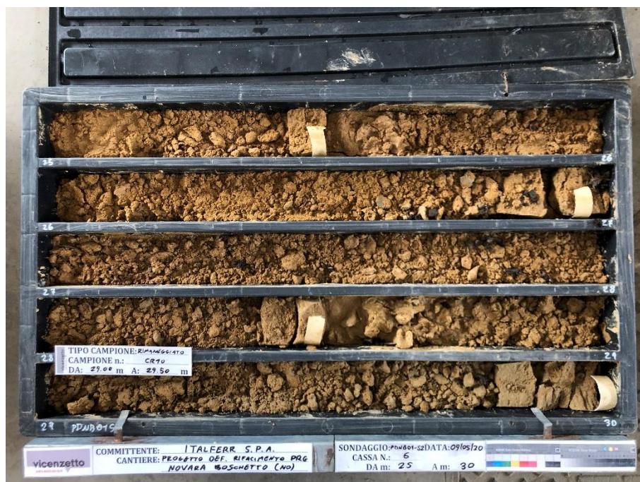
Figura 19 - Sondaggio PDNB01_S2, profondità 25,00-30,00
