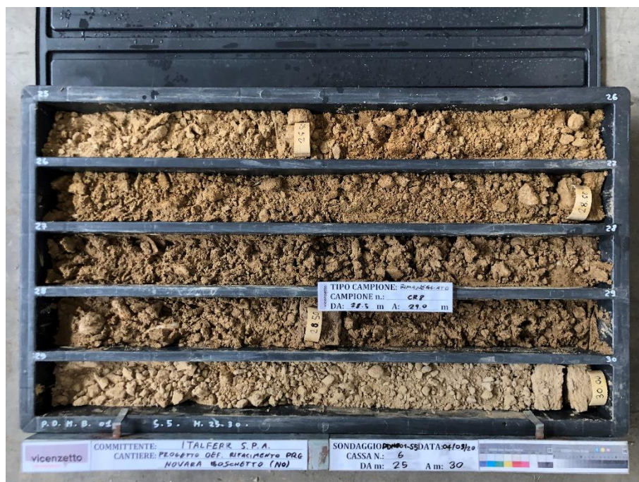
Figura 49 - Sondaggio PDNB01_S5, profondità 25,00-30,00
