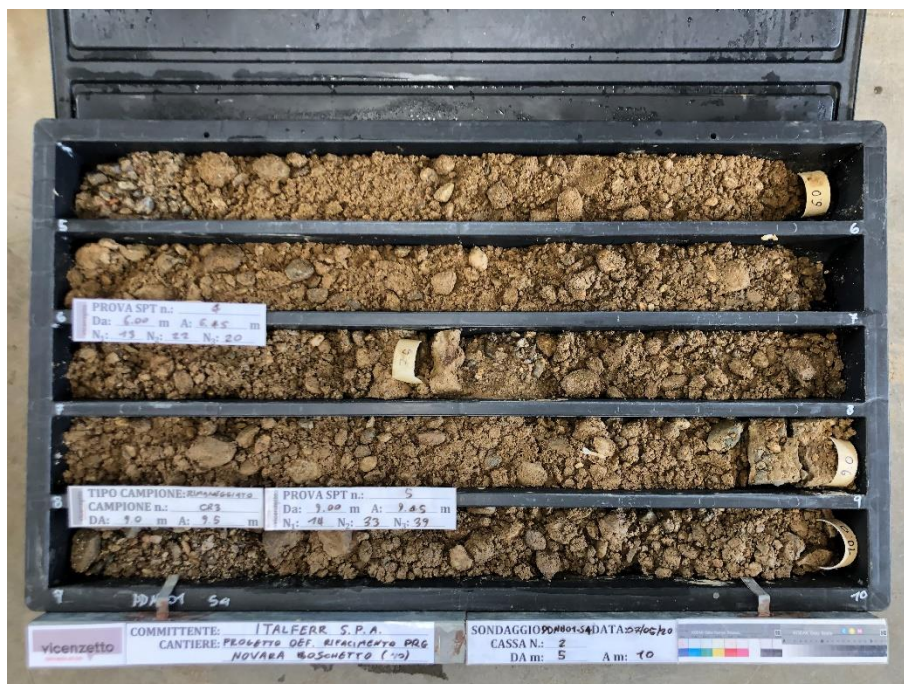
Figura 35 - Sondaggio PDNB01_S4, profondità 5,00-10,00m.
