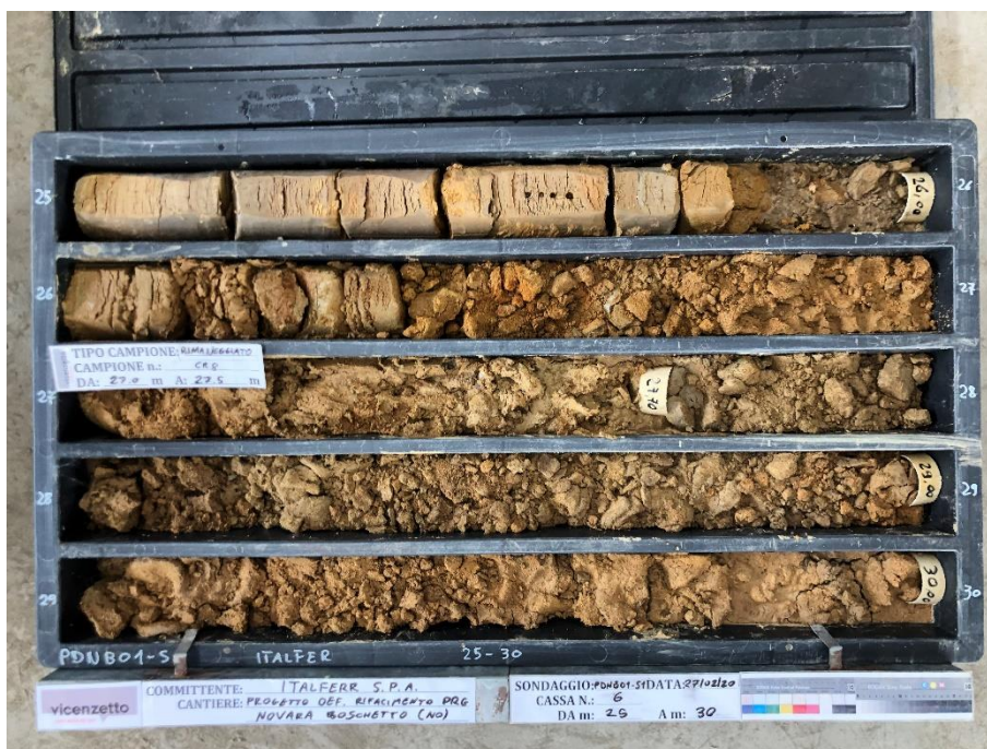
Figura 9 - Sondaggio PDNB01_S1, profondità 25,00-30,00
