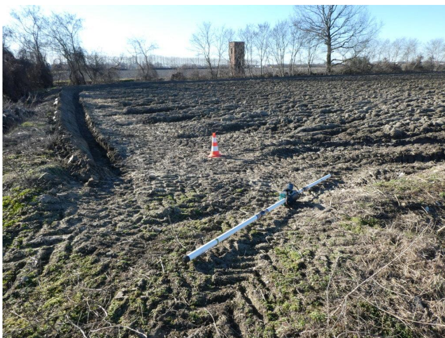
Figura 7 – Penetrometro approntato nella prova DPSH03
