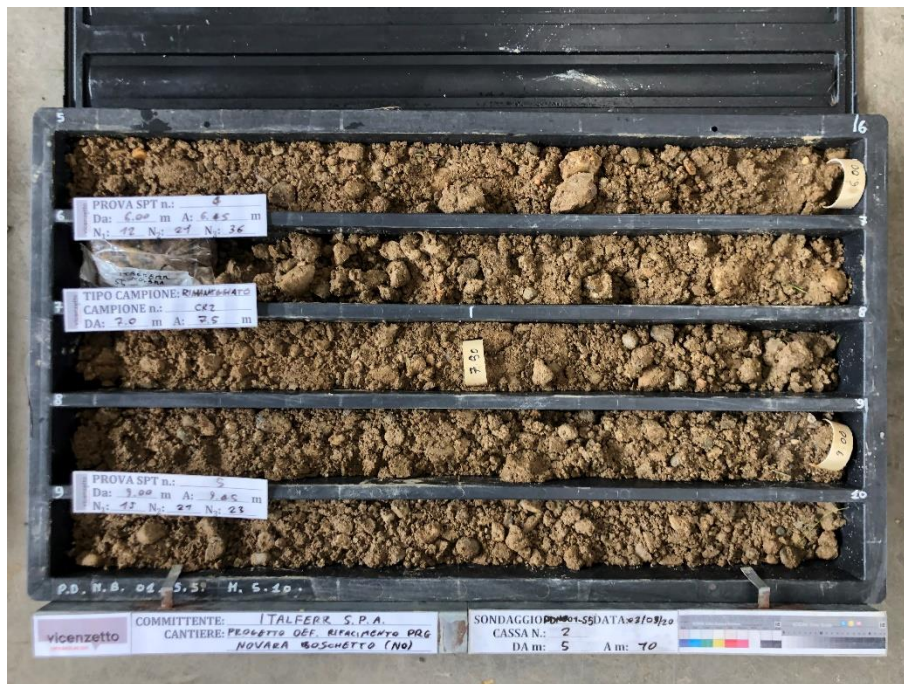
Figura 45 - Sondaggio PDNB01_S5, profondità 5,00-10,00m.
