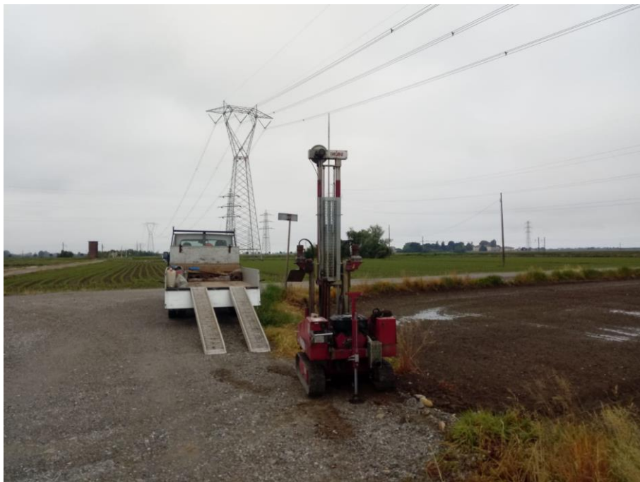
Figura 3 – Penetrometro approntato nella prova DPSH01
