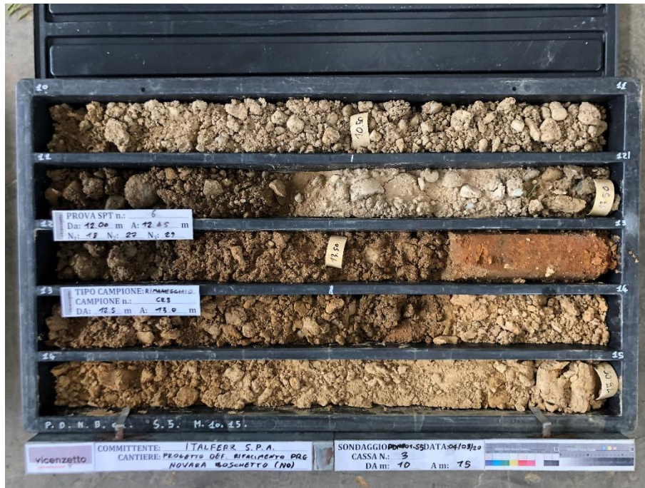
Figura 46 - Sondaggio PDNB01_S5, profondità 10,00-15,00m.
