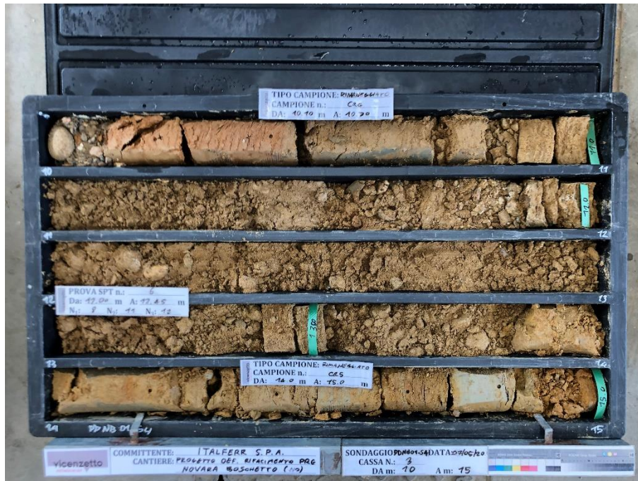
Figura 36 - Sondaggio PDNB01_S4, profondità 10,00-15,00m.
