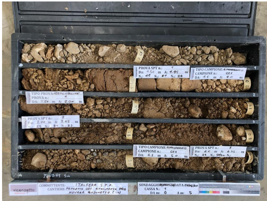
Figura 34 – Sondaggio PDNB01_S4, profondità 0,00 -5,00m.
