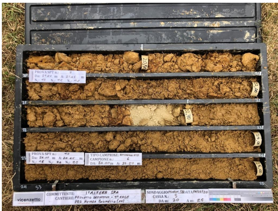
Figura 28 - Sondaggio PDNB01_S3, profondità 20,00-25,00m.
