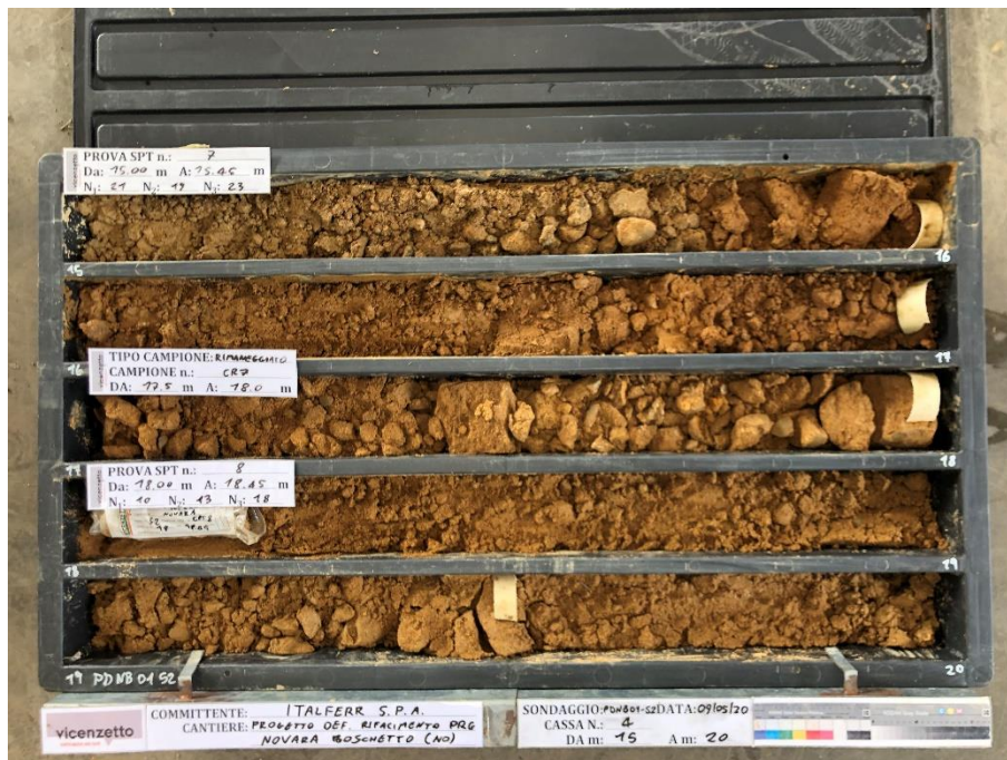
Figura 17 - Sondaggio PDNB01_S2, profondità 15,00-20,00
