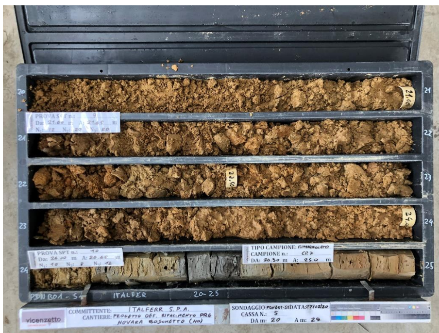
Figura 8 - Sondaggio PDNB01_S1, profondità 20,00-25,00m.
