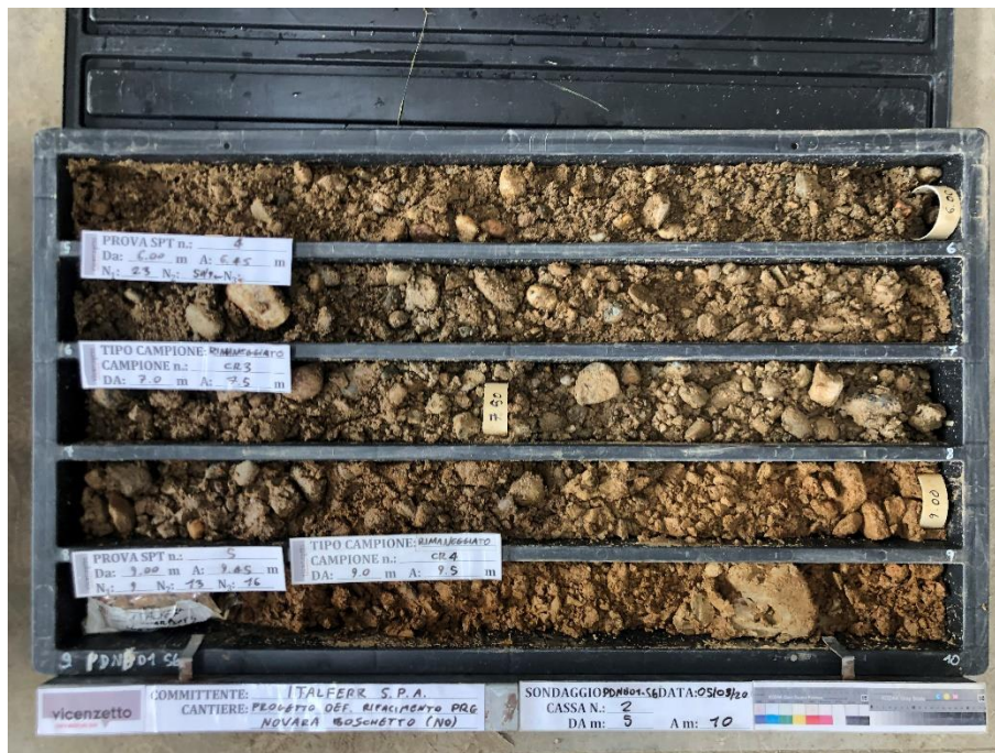
Figura 55 - Sondaggio PDNB01_S6, profondità 5,00-10,00m.
