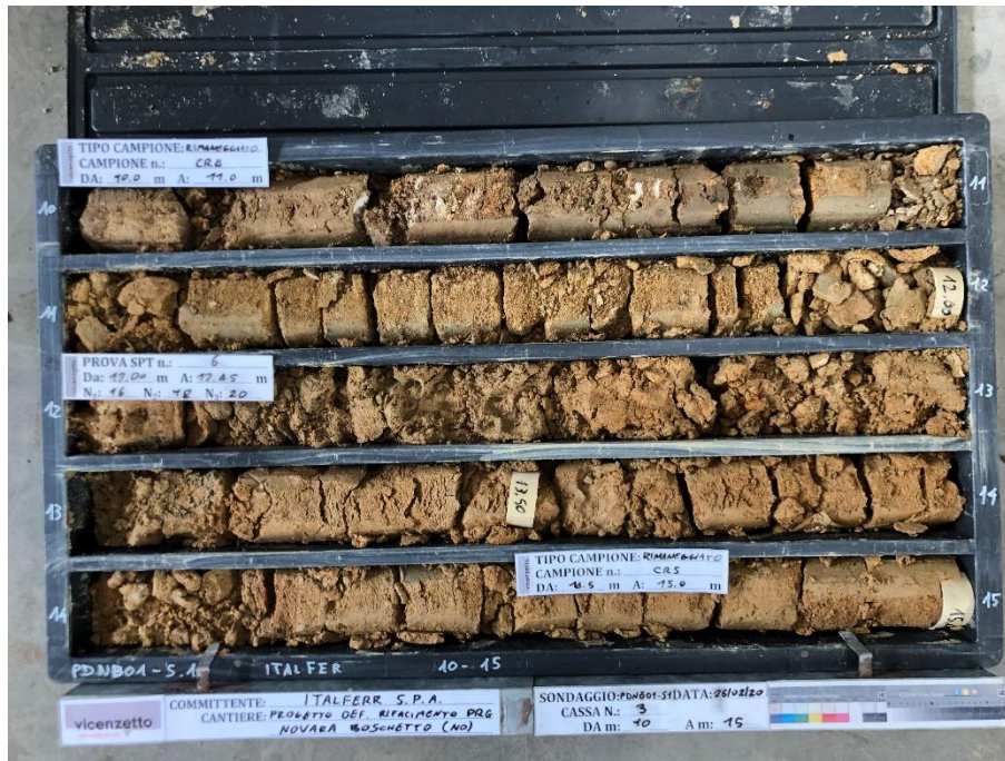
Figura 6 - Sondaggio PDNB01_S1, profondità 10,00-15,00m.
