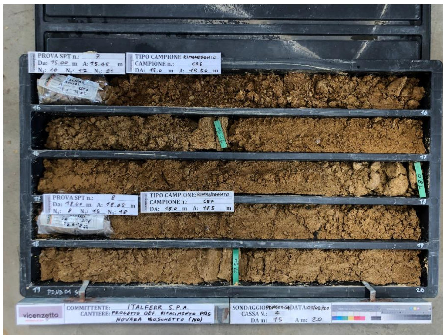
Figura 37 - Sondaggio PDNB01_S4, profondità 15,00-20,00
