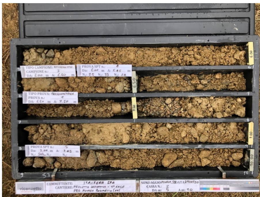
Figura 25 - Sondaggio PDNB01_S3, profondità 5,00-10,00m.
