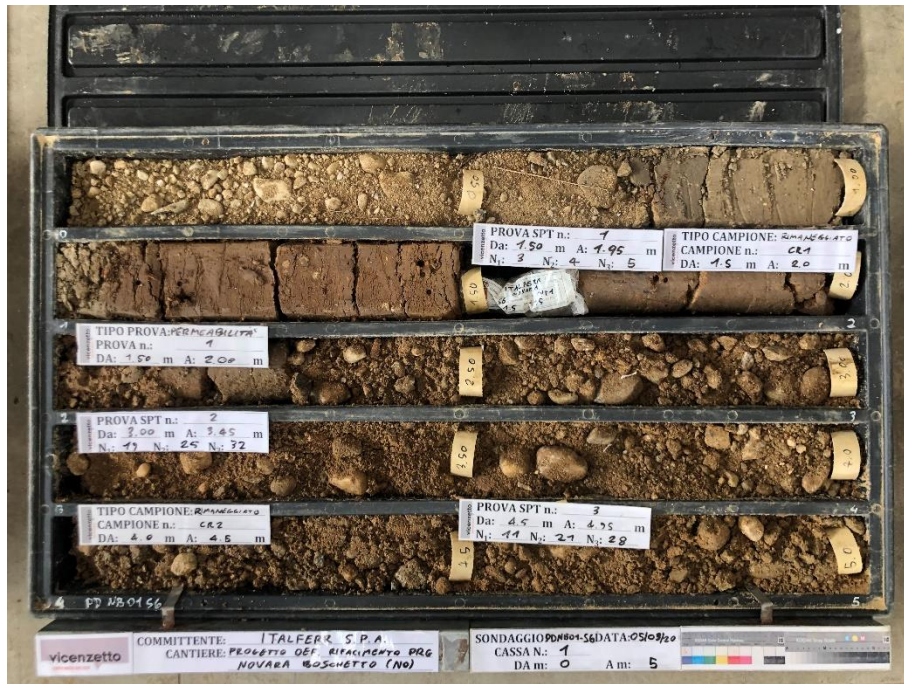
Figura 54 – Sondaggio PDNB01_S6, profondità 0,00 -5,00m.
