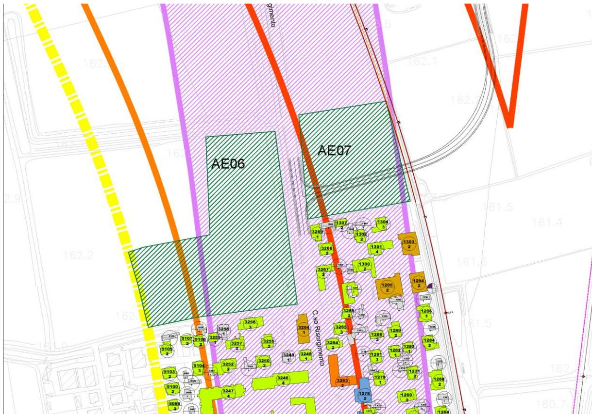
Le Aree di Espansione AE06 e AE07 si trovano nei pressi della fine dell'intervento sulla Linea Ferroviaria Novara-Domodossola. L'Area AE07 è in parte interessata dalla realizzazione di una viabilità funzionale alla soppressione PL. I Punti di Simulazione sono stati posizionati sia nella Fascia A che nella Fascia B di pertinenza acustica ferroviaria.
