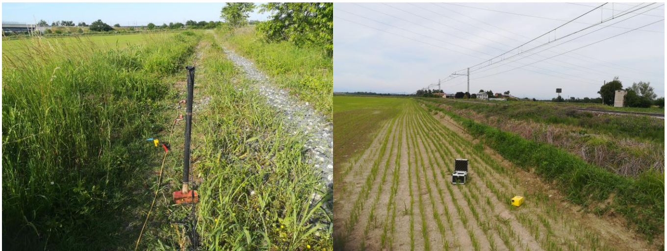
Figura 2: Strumentazione impiegata per le prove sismiche mediante metodologia MASW (a sinistra) e HVSr (a destra).
