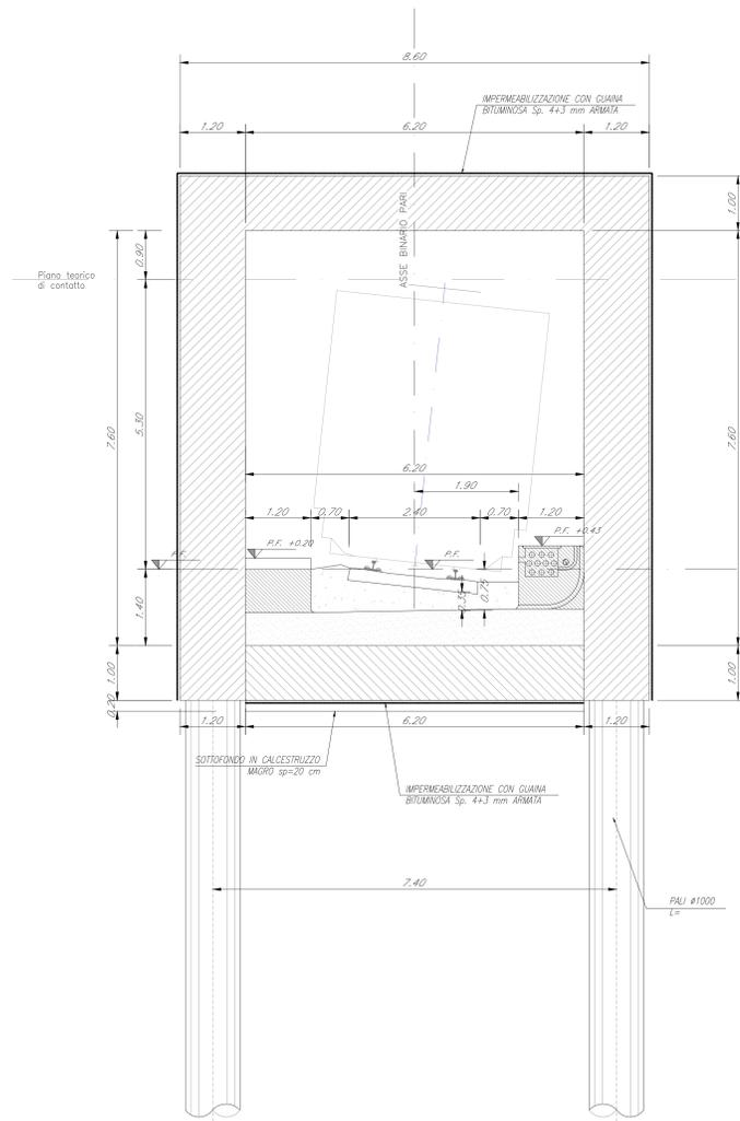
SEZIONE TIPO GALLERIA ARTIFICIALE CON PALI
