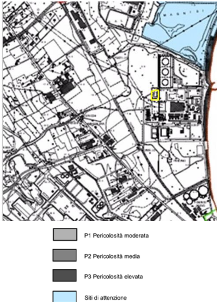
Figura 2.5.1 – Stralcio della carta della pericolosità idraulica per fenomeni di esondazione per l'area di interesse (in giallo l'ubicazione del BESS)
