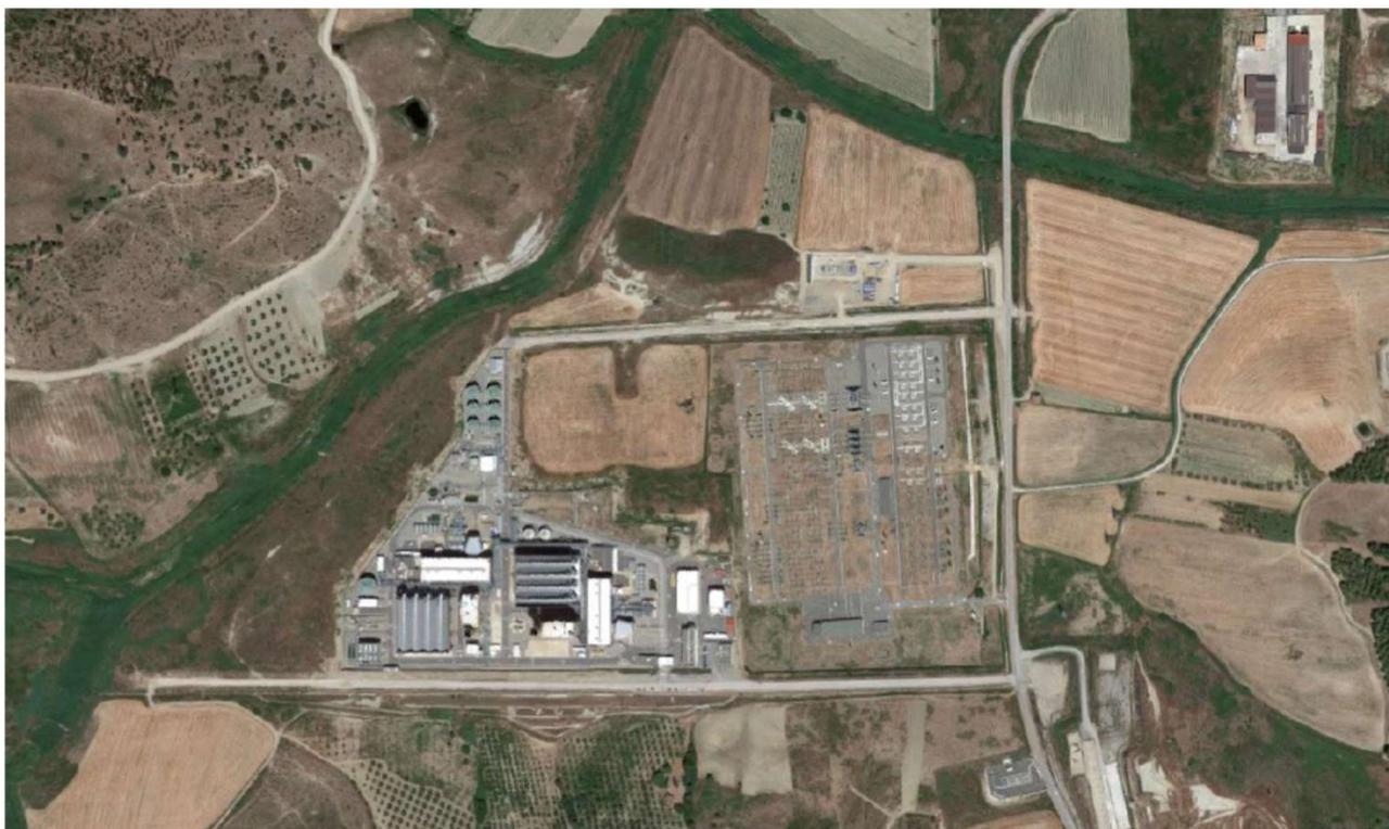
La Centrale di Scandale è composta da No. 2 gruppi generatori con architettura 1+1 multialbero, ognuno dei quali costituito da una turbina a gas, un generatore di vapore a recupero (GVR), una turbina a vapore e due generatori elettrici. In questa configurazione ogni turbina è collegata ad un generatore elettrico tramite un proprio albero.
