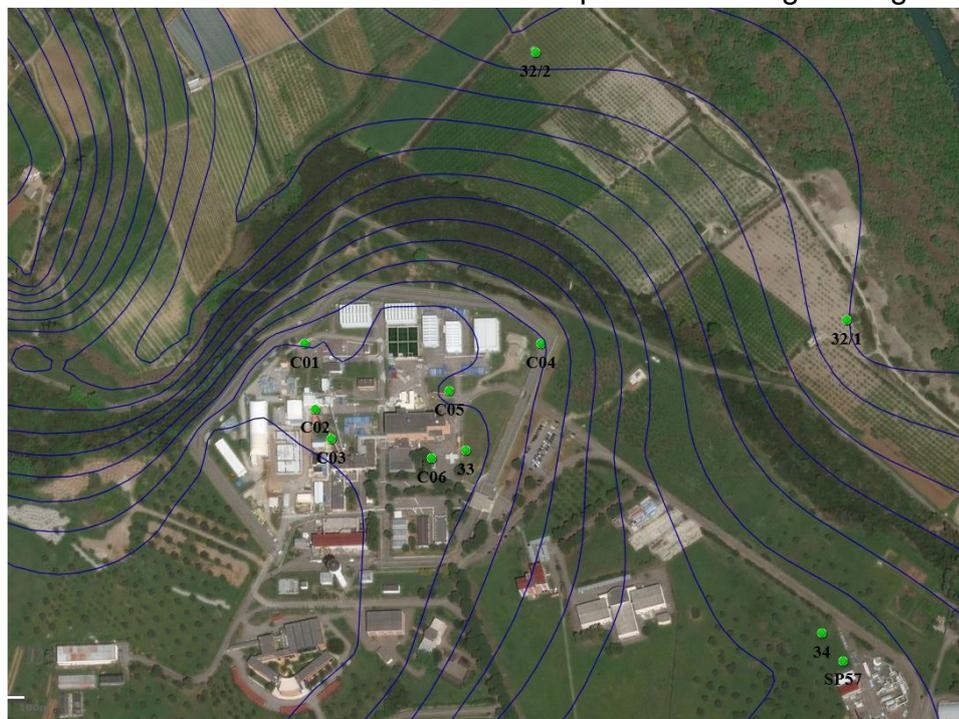
Figura 7.1 Piezometri della rete di controllo falda superficiale
