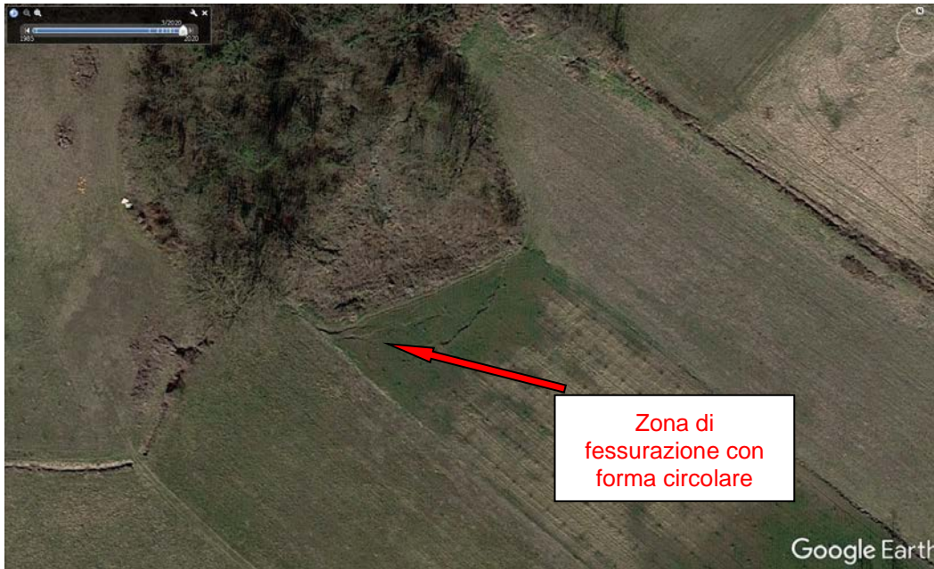
Figura 12 – Area 02, immagine satellitare che mostra la presenza di probabili fessurazioni.
