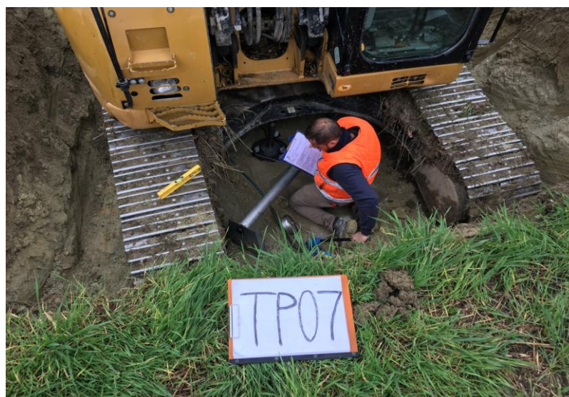
ESECUZIONE DI PROVA DI CARICO SU PIASTRA
