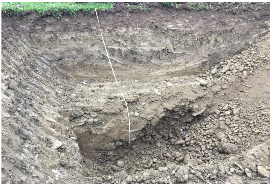
SCAVI DI POZZETTO ESPLORATIVO A 3,00 m
