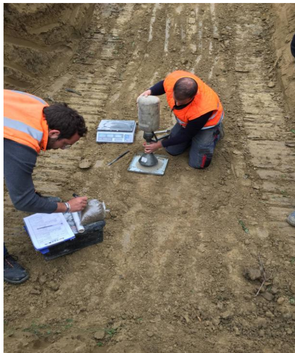
FASE DI ESECUZIONE DELLA PROVA DI DENSITA' IN SITU
