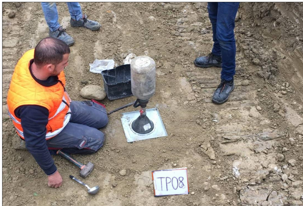
PROVA DI DENSITA' IN SITU
