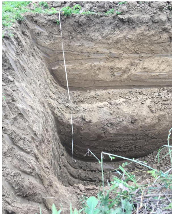
SCAVI DI POZZETTO ESPLORATIVO A 3,00 m
