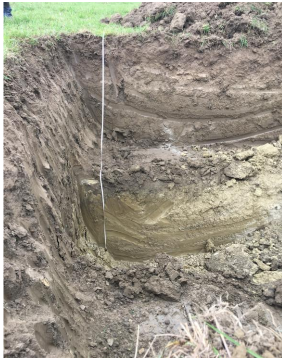
SCAVI DI POZZETTO ESPLORATIVO A 3,00 m
