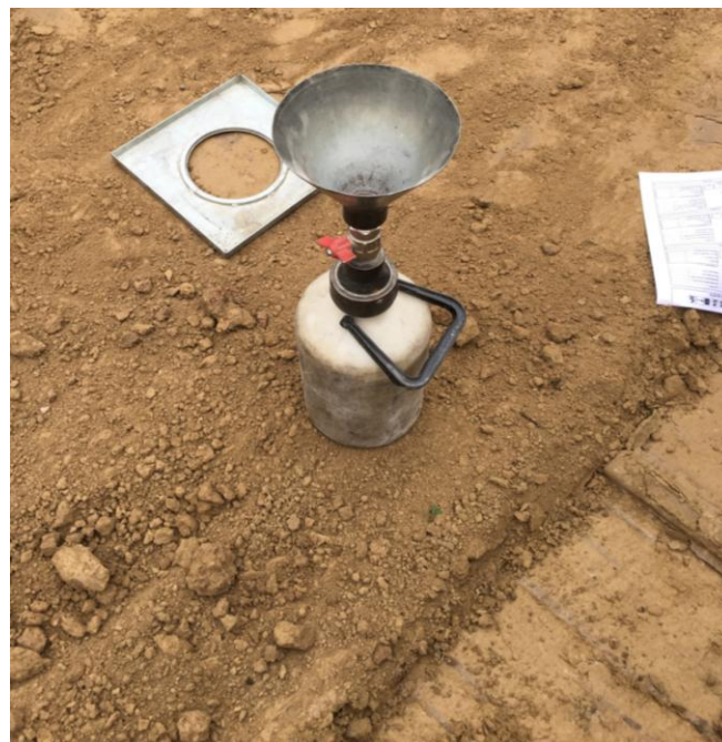
PROVA DI DENSITA' IN SITU
