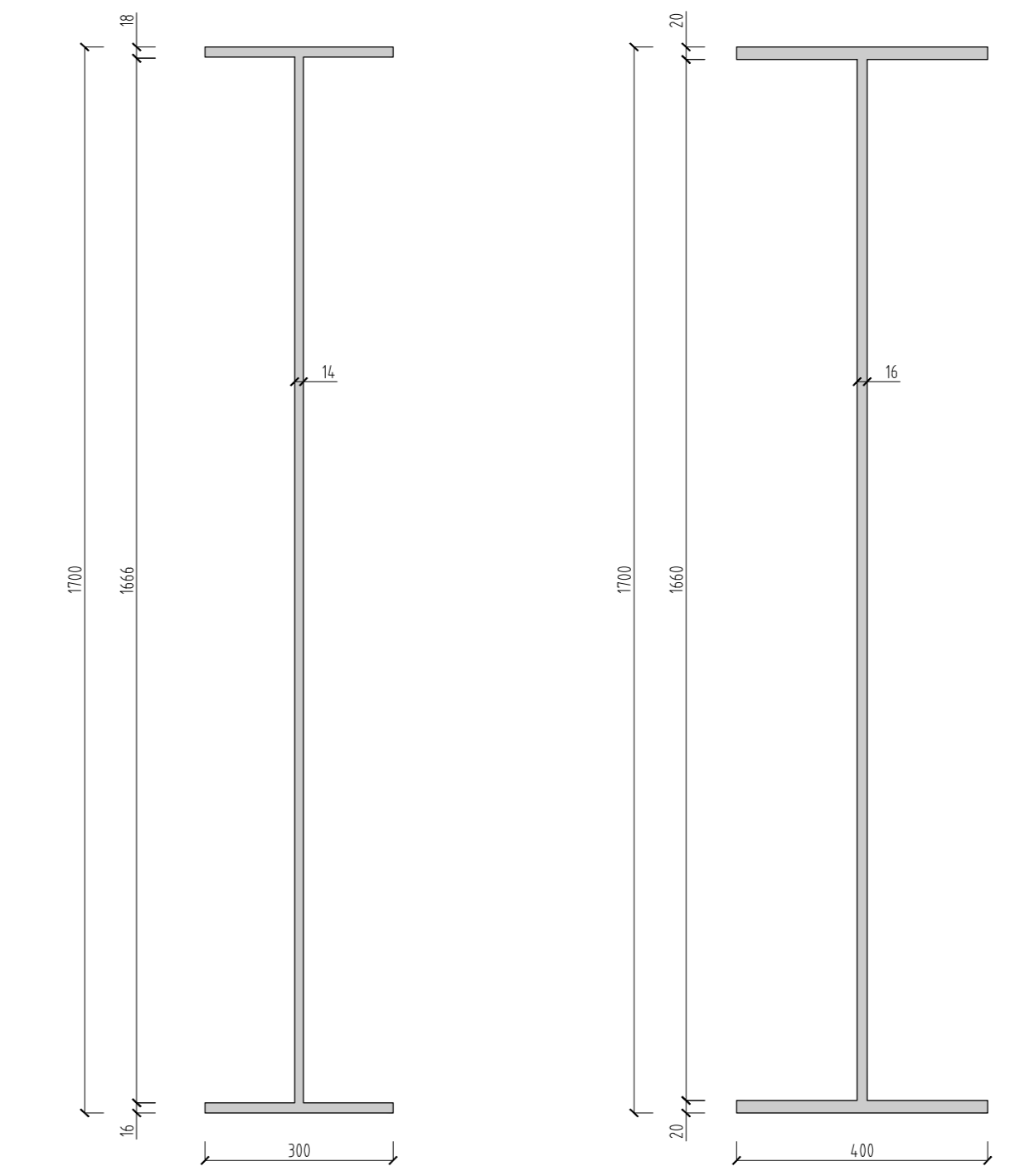
SEZIONE TRAVEVERSO DI CAMPATA DC (Scale 1:100)
