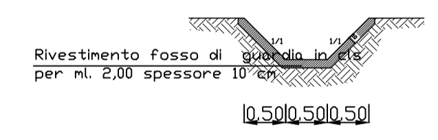
PARTICOLARE CANALETTA DI RACCOLTA ACQUE IN SCARPATA
