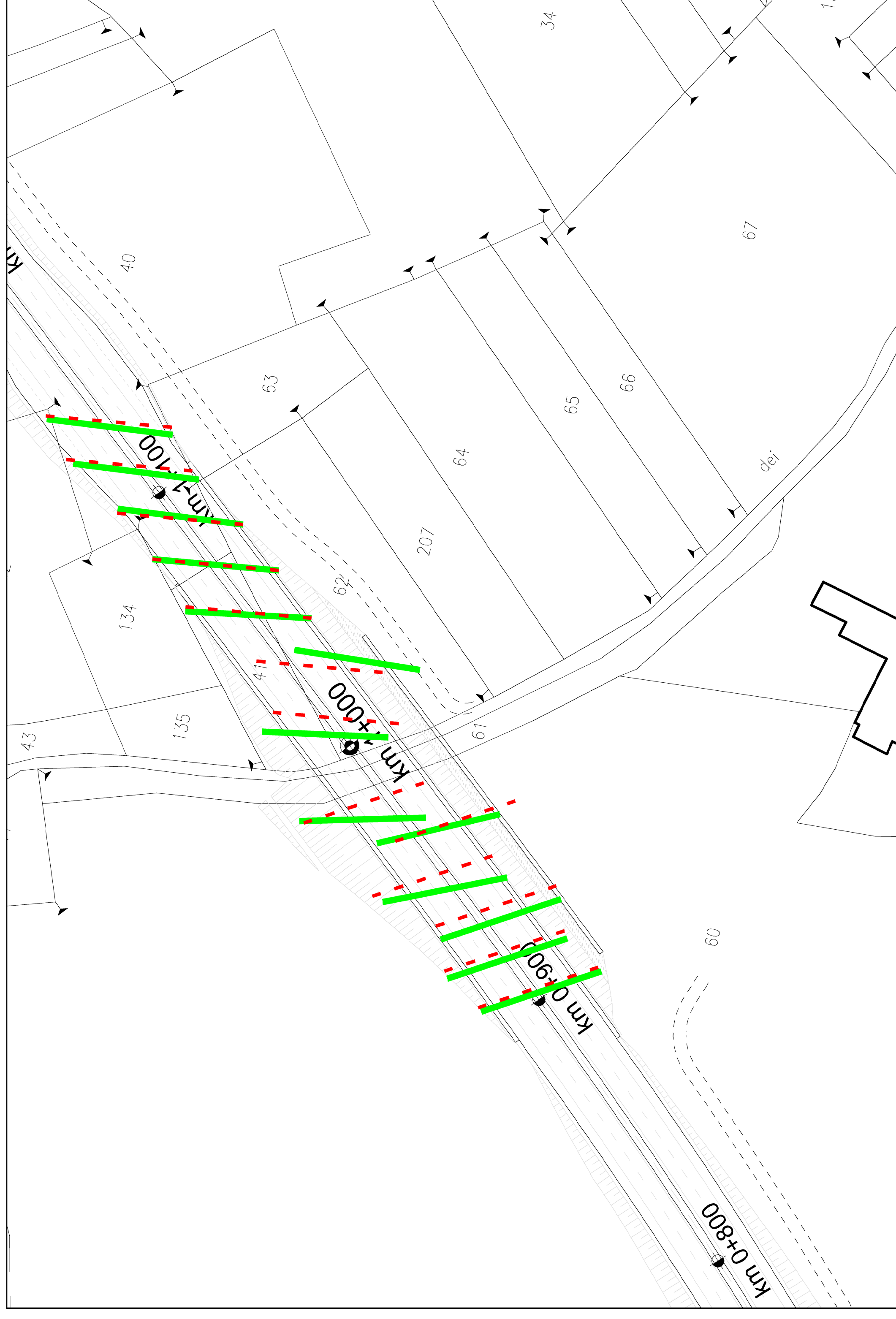
POSIZIONAMENTO INDAGINI SU CATASTALE scala 1: 1000
