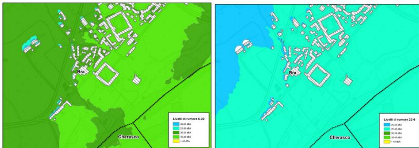
Figura 27 Esposizione acustica del castello Reale di Pollenzo nella fase post operam - periodo diurno (sx) e notturno (dx)
