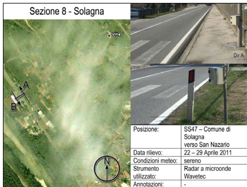
Figura 11 Scheda della Sezione 8. Planimetria e viste degli strumenti installati
