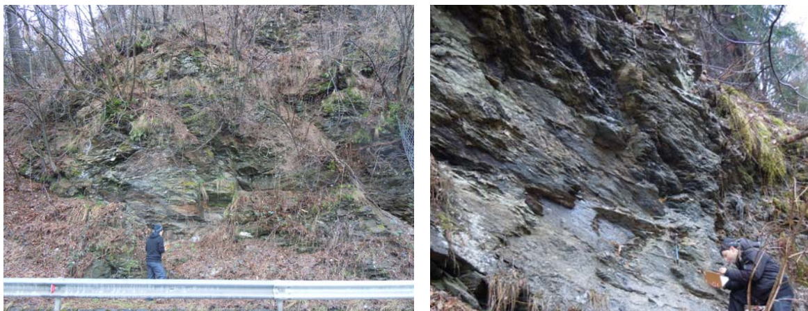
Figura 5-2 - Geologia – Sequenza stratigrafica – Affioramento delle filladi quarzifere del basamento cristallino n°28a lungo la val di Centa
