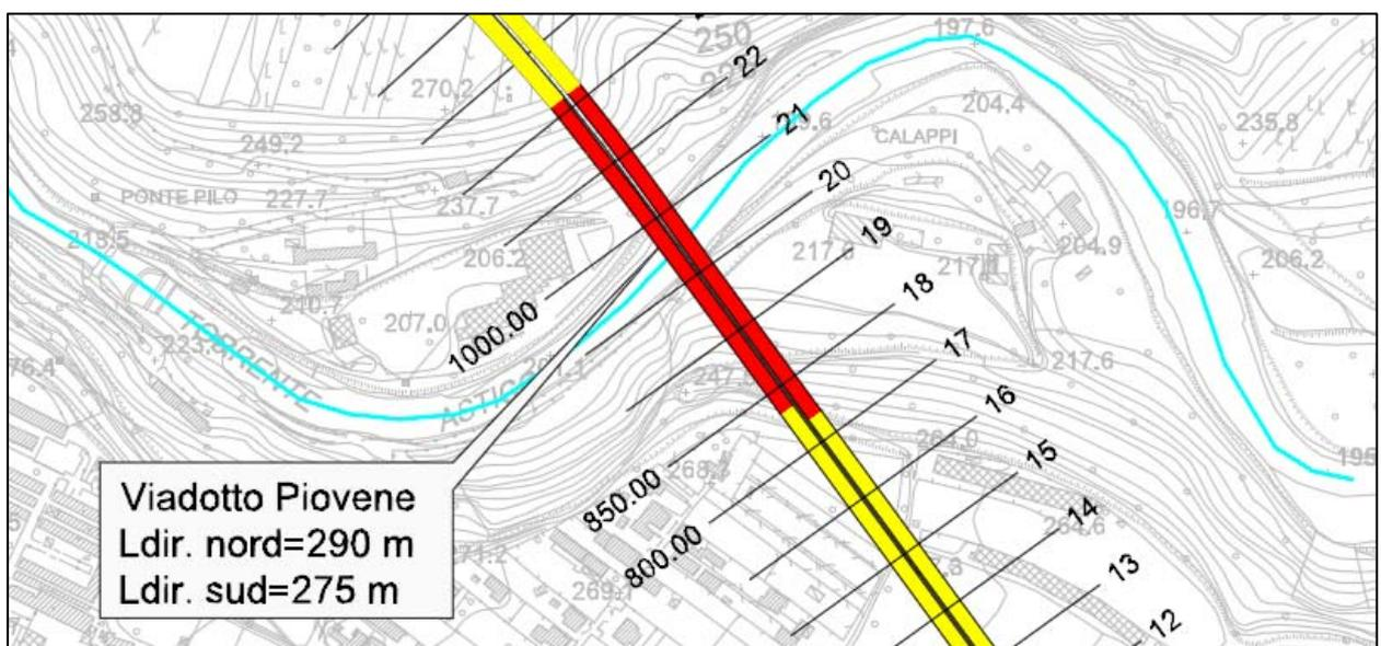
Figura 50 Localizzazione del tratto numero 6 più a sud, modellizzato per lo studio delle interferenze del tracciato con l'Astico
