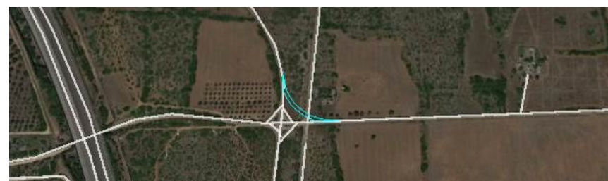
Figura 14 - Imbocco della strada di accesso all'aerogeneratore A03 che necessita di un allargamento temporaneo sulla sinistra e dell'abbattimento di pochi alberi sulla destra.
