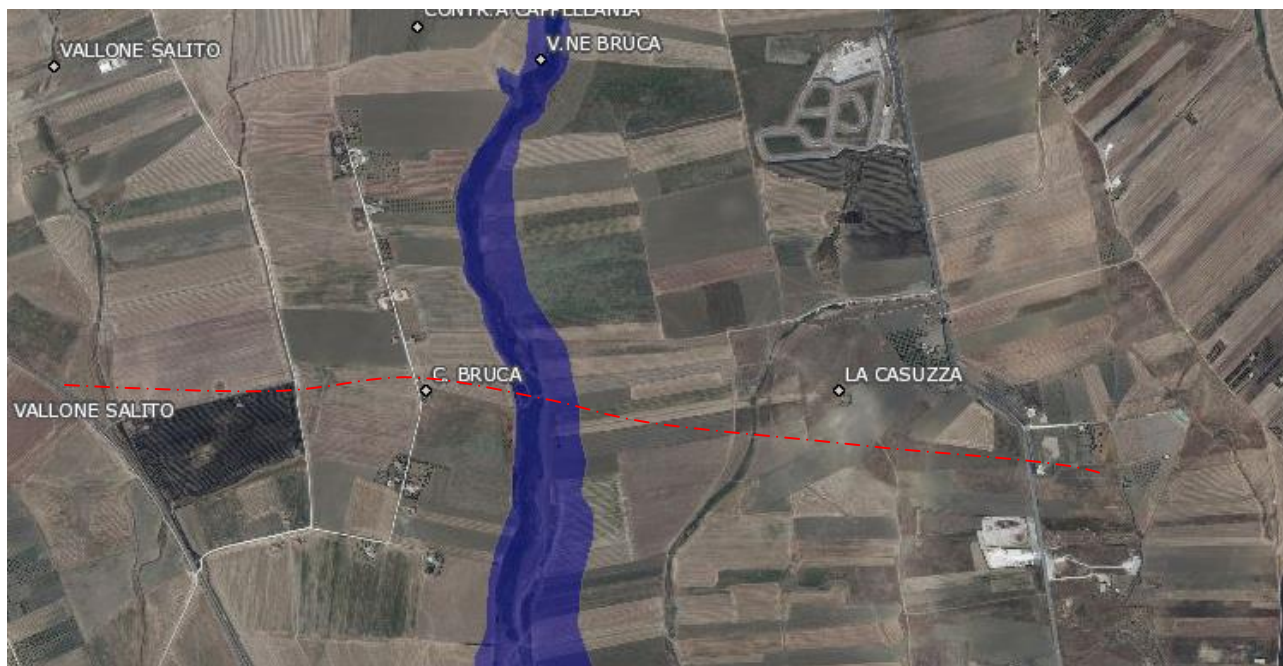
Stralcio planimetrico PGRA 2021 Estensione dell'area allagabile Vallone Bruca (Fonte: Geoportale Nazionale - Minambiente)
