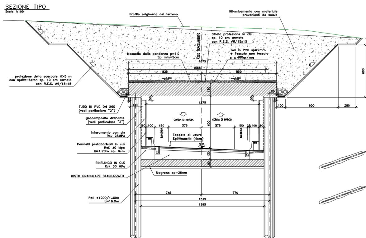
Figura 3.9 sezione tipo galleria artificiale
