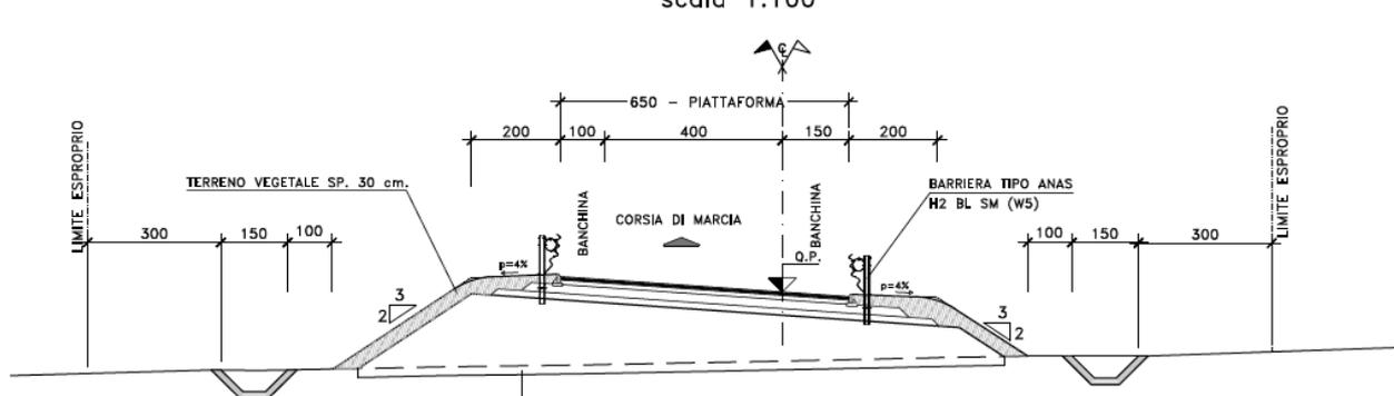
Figura 3.2 Sezione tipo Rampa di svincolo unidirezionale
