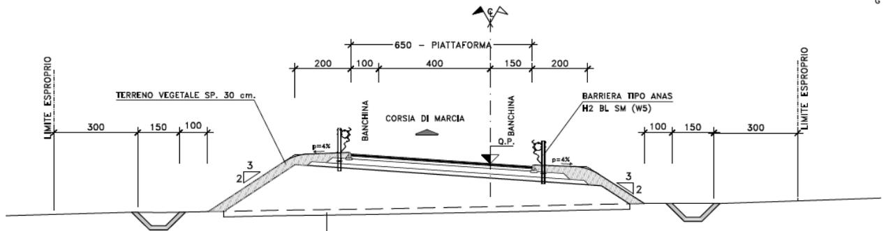
Figura 4-2- Sezione tipo Rampa di svincolo unidirezionale
