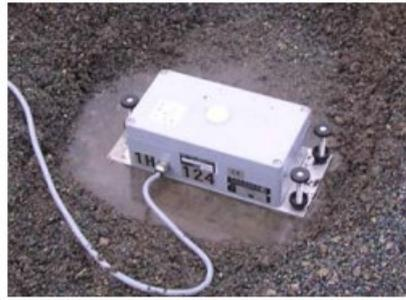
**Figura 6-2. Esempio di geofono triassiale**
