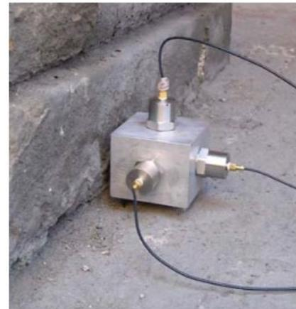
**Figura 6-1. Esempi di accelerometri (a sinistra accelerometro triassiale, a destra tre accelerometri triassiali)**
