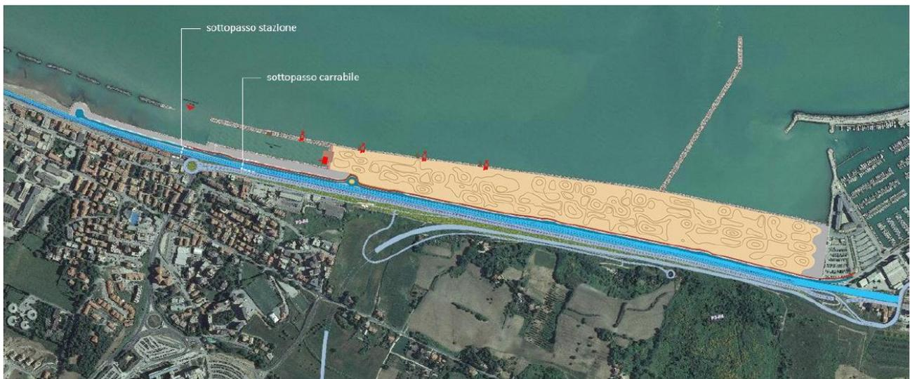
Figura 5 – Progetto di fattibilità tecnico economico lotto 2 l'ampliamento da 2 a 4 corsie della S.S. 16 Adriatica nel Comune di Ancona in affiancamento al progetto inerente al presente SIA. Spostamento pista ciclabile lato mare e realizzazione sottopasso ciclabile carrabile zona Torrette.
