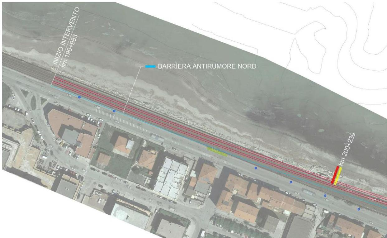
Fig. 1: tratto di barriere acustiche dove è necessario opere di drenaggio stradale: Dal km 199+983 al km 200+239.
