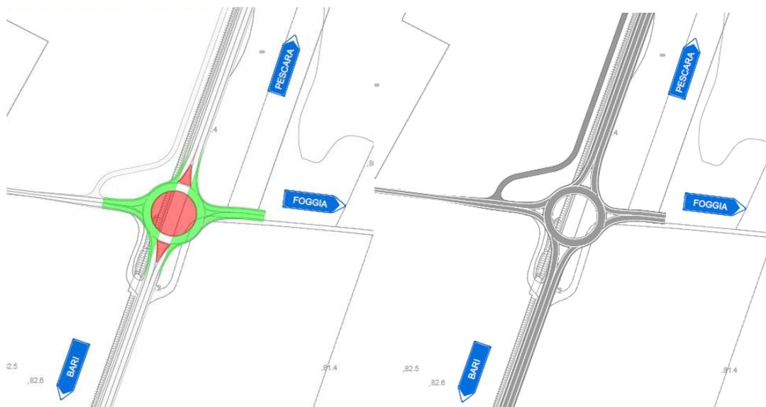
Figura 51 – Cantierizzazione tipologica intersezioni a rotatoria – Fasi 3 e 4
