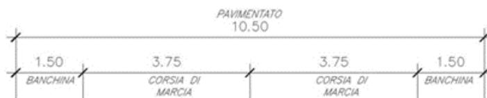
**Figura 3 – Sezione Tipo C1**
