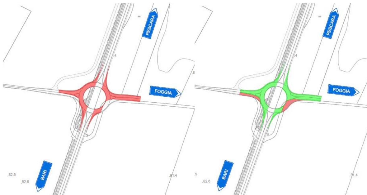
Figura 50 - Cantierizzazione topologica intersezioni a rotatoria – Fasi 1 e 2
