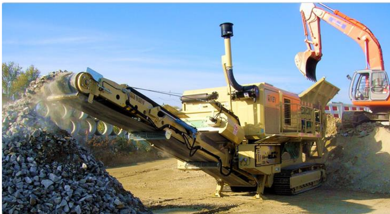
Figura 5.5 – Tipico frantoio mobile per il riutilizzo in sito delle rocce da scavo
