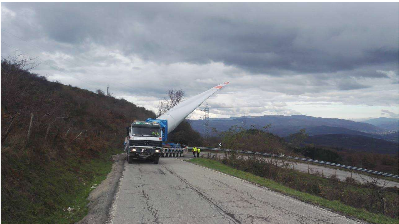
Fig. 8 : mezzo trasporto eccezionale speciale pala (blade lifter)
