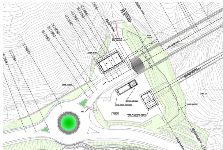
Figura 15 – Sistemazione imbocco lato Umbria
